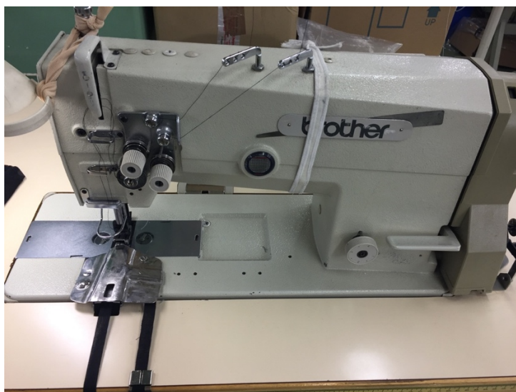
Joonis 5.2 Õmblusmasin ja lisaseadmed tunnelpaela ühendamiseks. Autori foto.
