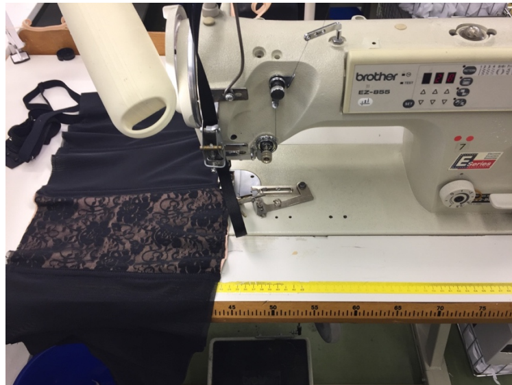
Joonis 5.3 Silikoonpaela ühendamiseks vajalikud lisaseadmed ja õmblusmasin. Autori foto.
