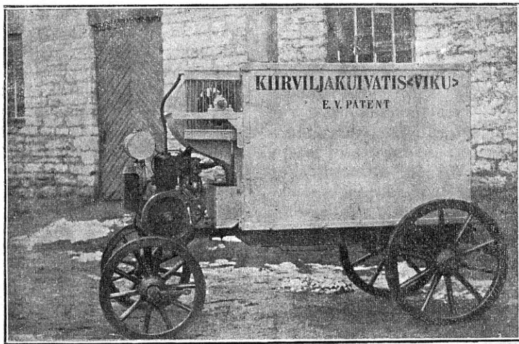
Joon. 1. Kiirviljakuivatise „Viku“ õhusoojendusahju küljevaade (paremalt poolt).
