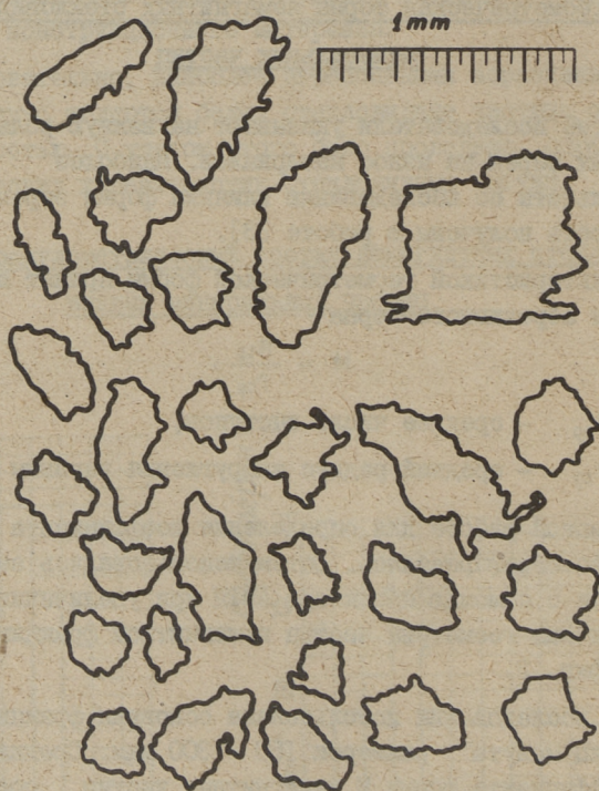
Фиг. 2. Геометрия минеральных частиц немагнитной фракции мазута.
