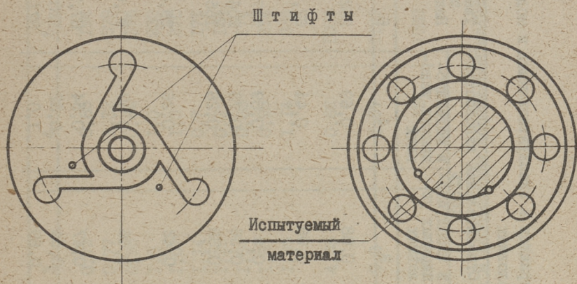
Фиг. 2. Форсунка для испытания материалов на износостойкость.
