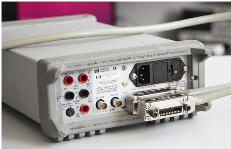
Joonis 8.3. IEEE-488 kaabli ühendus mõõteseadmega (foto – T. Eikholm)
