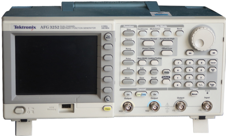
Joonis 4.9. Suvalise lainekuju generaator AFG32522 (Tektronix, foto – T. Eikholm)
