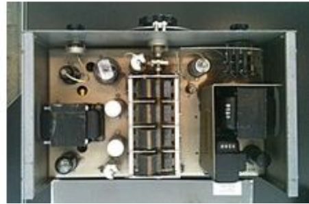
Joonis 1.4. Hewlett-Packardi HP 200A sisemus (CC BY-SA 2.0 / Wikimedia Commons).
