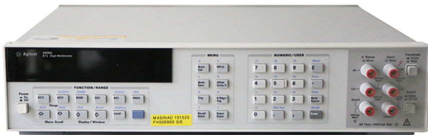
Joonis 4.6. Digitaalne multimeeter 3458A (Keysight, foto – T. Eikholm)
