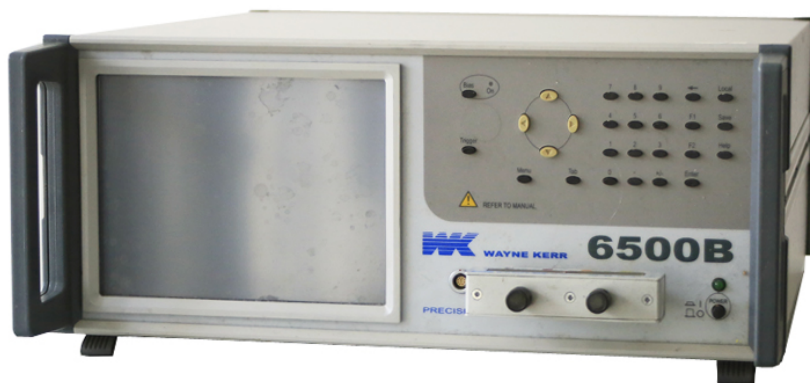
Joonis 4.10. Wayne-Kerr 6500B impedantsi mõõtja (foto – T. Eikholm)
