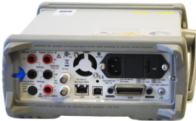
Joonis 4.5. Digitaalne multimeeter 34411A (Keysight), tagapaneel (foto – T. Eikholm)
