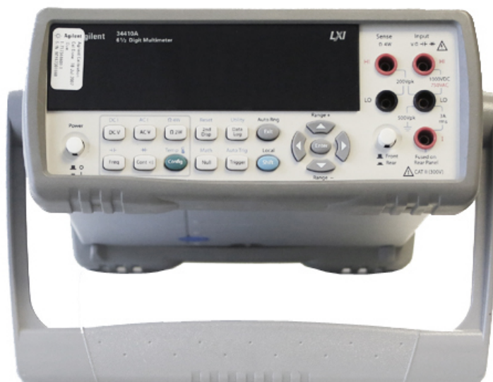
Joonis 4.4. Digitaalne multimeeter 34410A (Keysight), eestvaade (foto – T. Eikholm)
