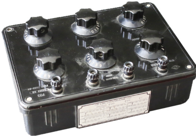
Joonis 6.4. Takistusmagasini näide (foto – T. Eikholm)
