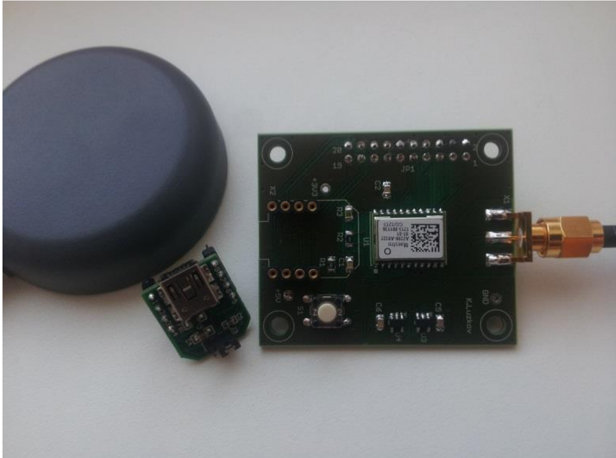
Joonis 6. Maestro A2200-A GPS moodul koos anteni ja UART-USB konverteriga
