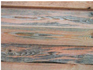
Joonis 2.2 Sinetusseened puidul[2]
