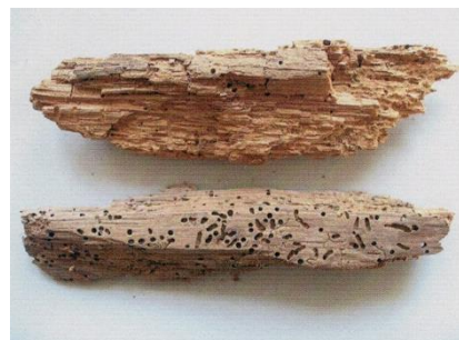
Joonis 2.8 Toonesepa kahjustatud puit[2]
