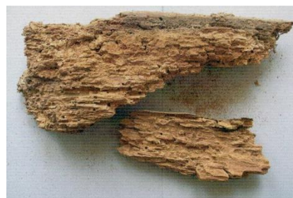
Joonis 2.2 Kärsaklaste kahjustatud puit[2]
