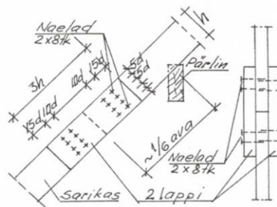
Joonis 4.2 Sarikate jätkamine külglappidega [11]
