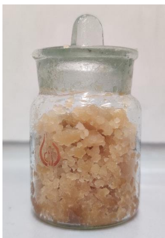
Joonis 2.4 Reaktsioonisegu pärast hoiustamist 20 h 40°C ahjus
