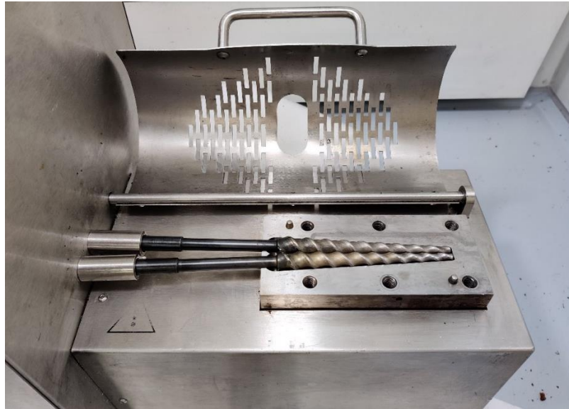
Joonis 2.7 Kaheteoline segamisekstruuder, nähtaval kruvid
