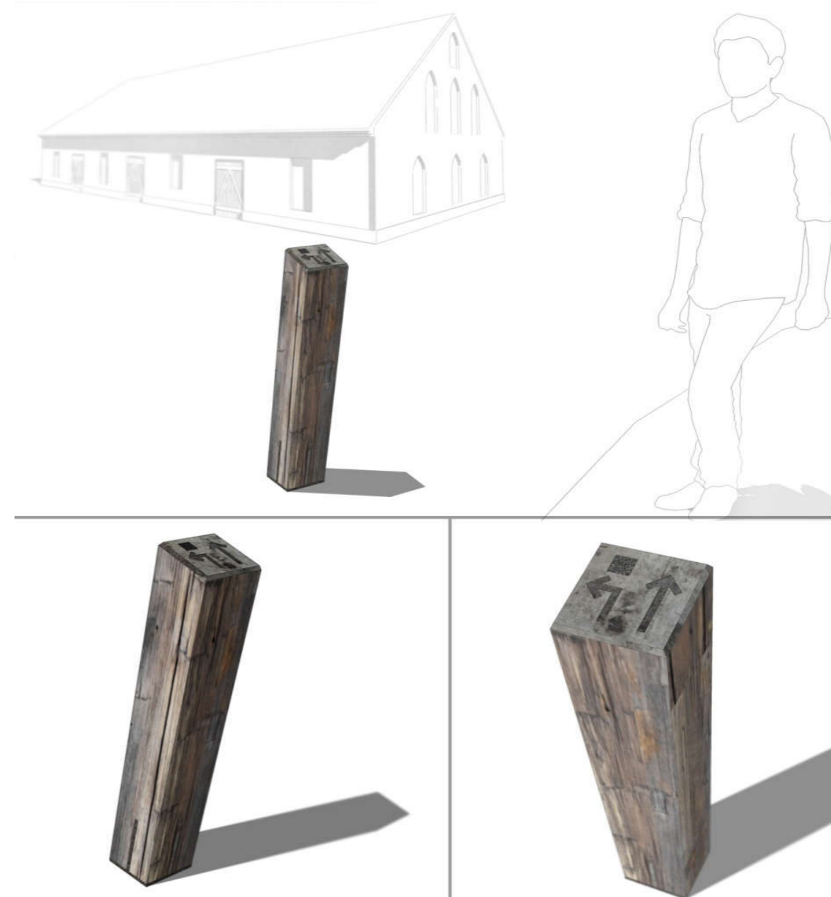
Joonis 65. Suunavaiad on varustatud vaid metallplaati freesitud suunanooltega, millest üks suunab rada nr 1 ja teine rada nr 2. Lisaks on vai varustatud QR koodiga, mis võimaldab huvi või vajaduse korral mobiilselt tutvuda asukoha, raja kaardi ja lisainformatsiooniga. Vaiad on valmistatud 150x150 mm tahatud pinnatöötlemisega ja halli tooni puidupeitsiga kaetud lehise nelikantprussidest. Vaiad kinnituvad maasse 10 kraadise nurga all, nii et infoplaadid on suunatud raja poole. Seetõttu väheneb postide märgatavus maastikus ka optiliselt. Nähtavad metallosad on valmistatud 10 mm paksusest rauast, mille pind on harjamise ja täkestamisega vanutatud ja kaetud roostetamise kaitseks ilmastikukindla lakiga. Nii säilib pindadel tumedam hall ja vanutatud välimusega pinnatöötlus.
