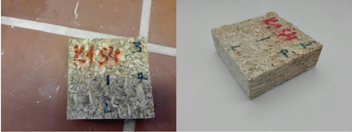
Joonis 15. Vasakul katsekeha enne ja paremal pärast vee alla panemist
