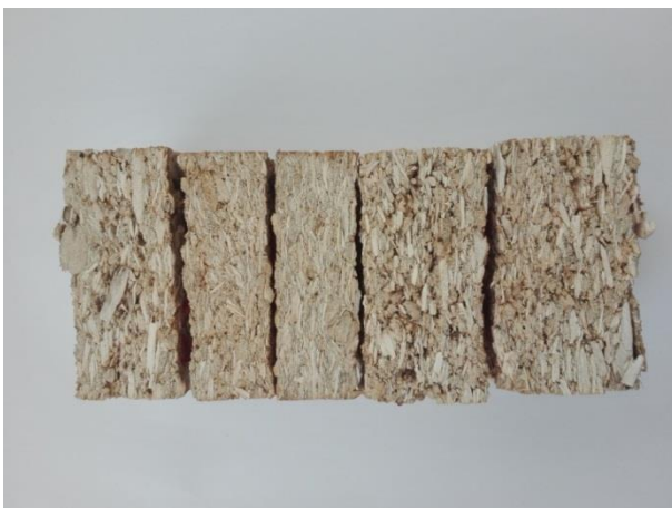
Joonis 24. Kanepiluuplaadist katsekehad peale veeimavuse ja pundumise katset
