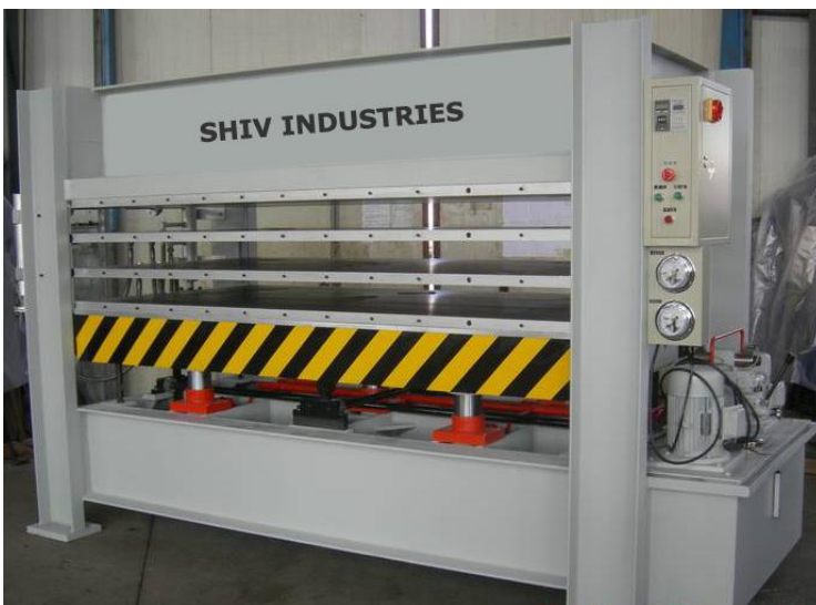
Joonis 7. Laastplaadi hüdrauliline lamepress [16]
