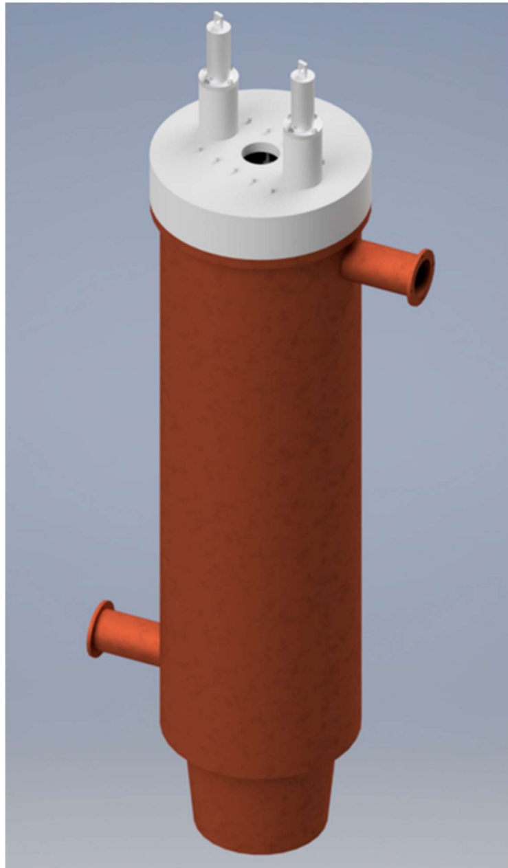
Joonis 2.2 Modelleeritud elektrostaatilise filtri koost
