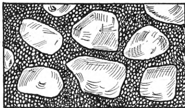
Joon. 9. Mida mitmekesisema suuruse terastikuga on liiva ja kruusa segu, seda tihedam on betoon ja seda vähem on vaja tsementi betooni tugevuse ja tiheduse saavutamiseks.
