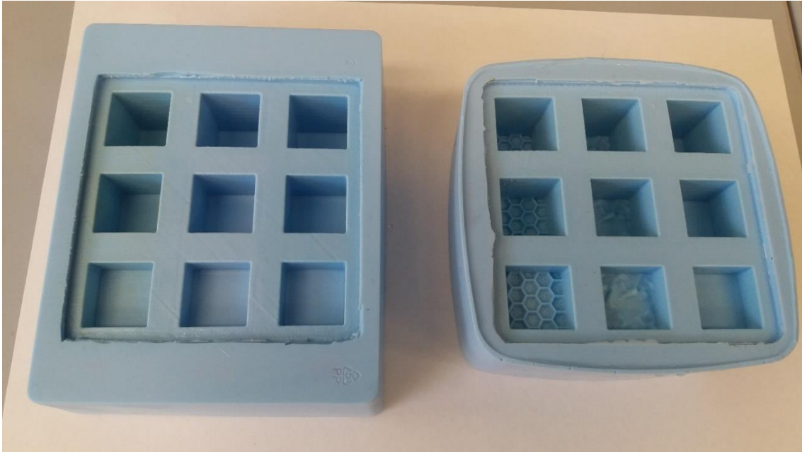
Joonis 7. Silikoon vorm 2 cm x 2 cm katsekehade valmistamiseks
