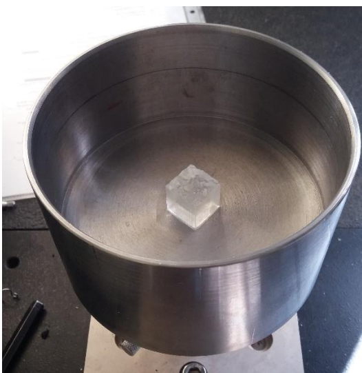
Joonis 8. Survekatse aparatuur ja katsekeha asetus
