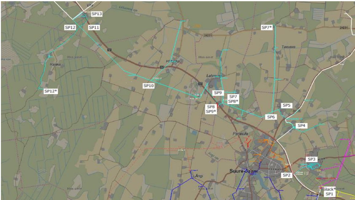
Trimble NIS väljavõtte Suure-Jaanis olevast 15kV keskpinge fiidrist (türkiissinine)
