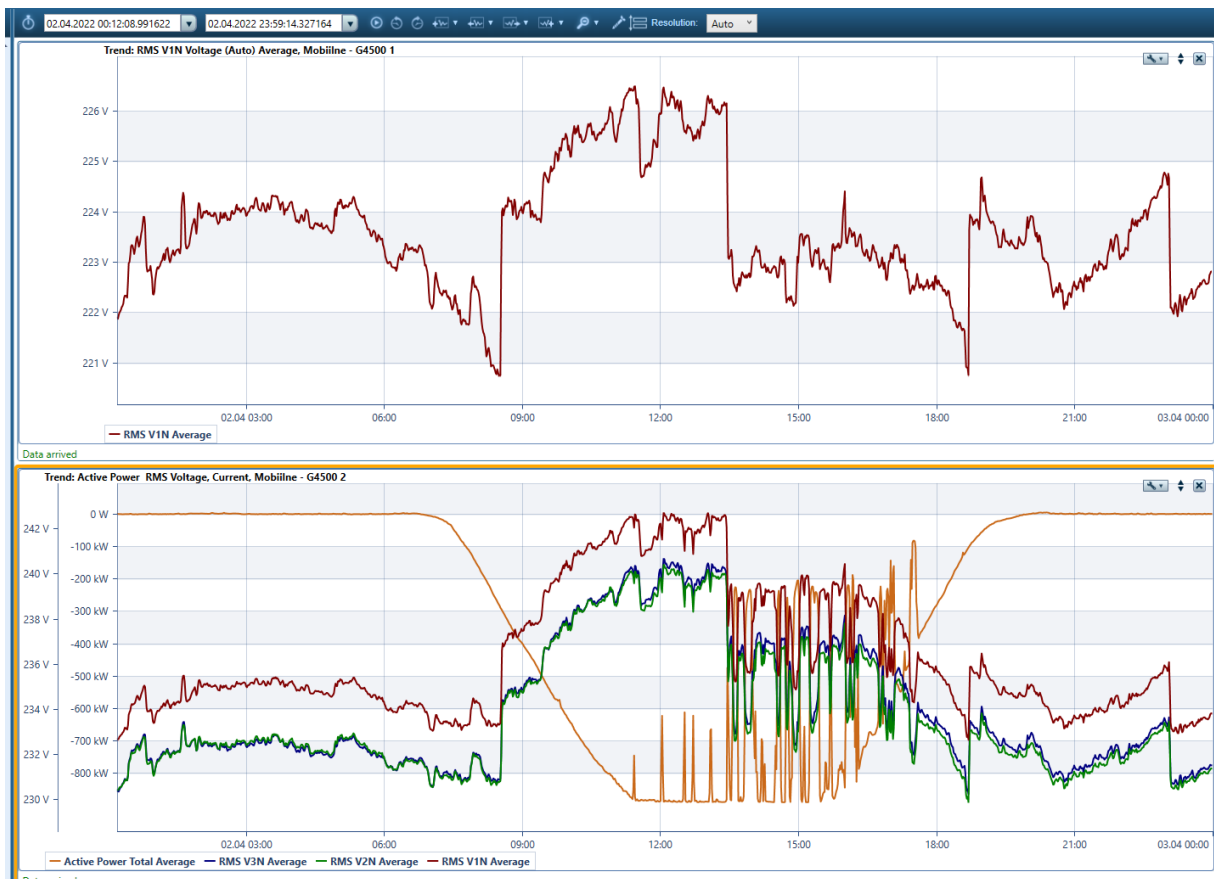
Joonis 2.22 04.2022 vaatlusperioodi Sõlmpunkti X U_1 faasipinge ja Sõlmpunkti Y faasipingete ning tootmise aktiiv- ja reaktiivvõimsuse mõõtetulemused ööpävasel ajavahemikul
