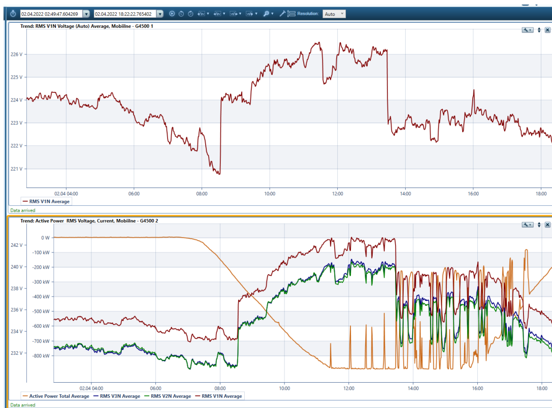
Joonis 2.33 Sõlmpunktide SP3 ja SP8 02.04.2022 vaatlusperioodi faasipinge ja päikeseelektrijaama (alumises osas) tootmise aktiivvõimsuse mõõtetulemused
