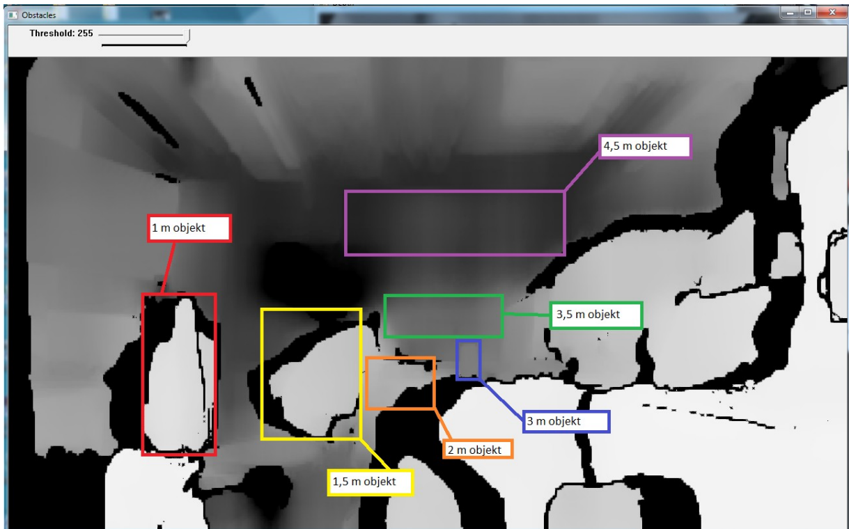
Joonis 3.9. Kuus objekti 1 m, 1,5 m, 2 m, 3 m, 3,5 m ja 4,5 m kaugusel. Testi illustratsioon.
