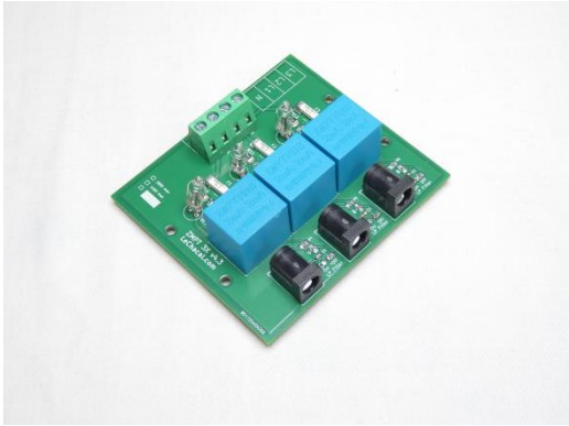
Joonis 2.4 Vahelduvvoolu pingemuundur ZMPT 3X v3.0
