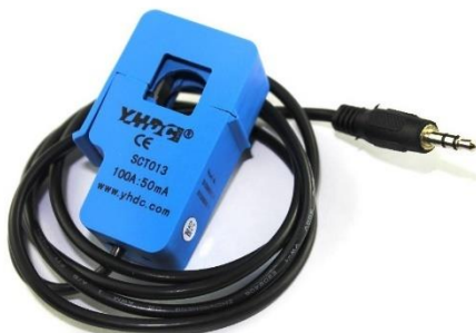
Joonis 2.3 Voolutrafo SCT013-100
