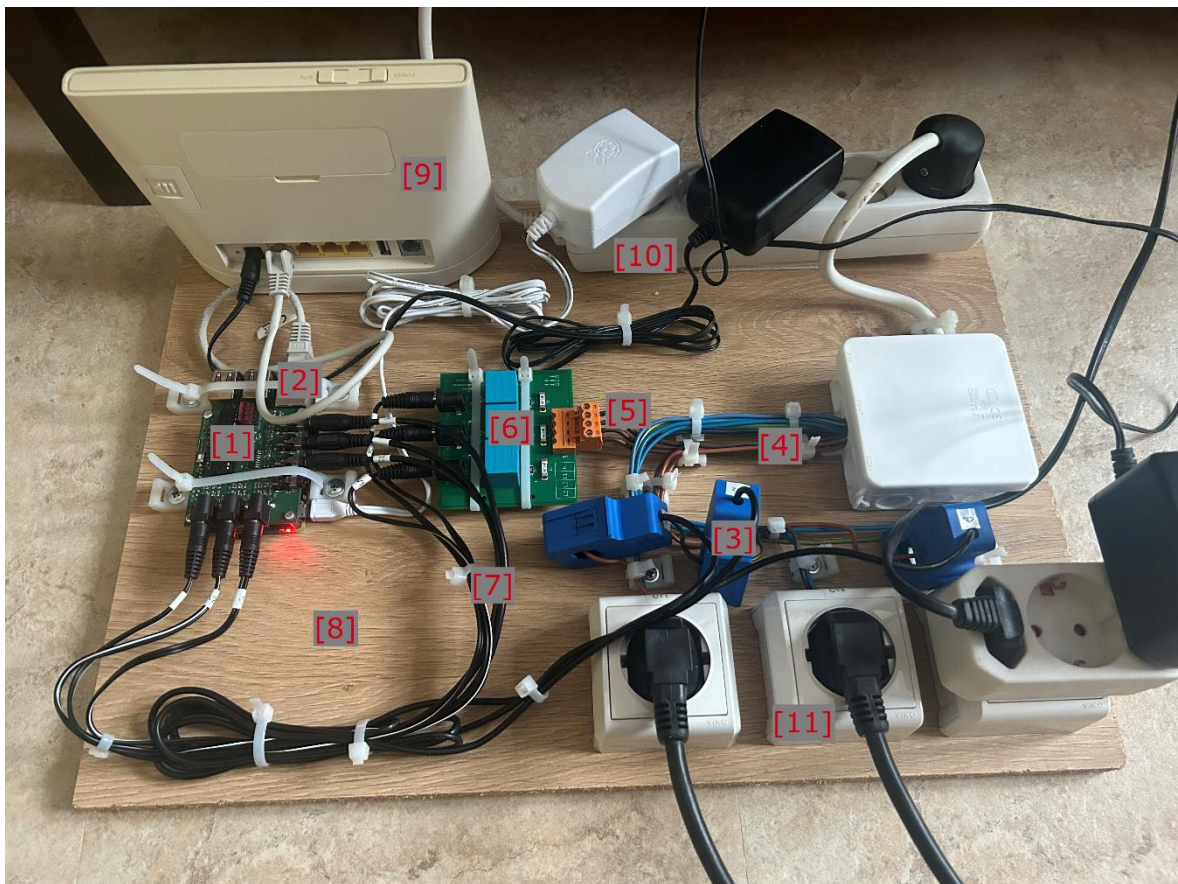
Joonis 2.6 Mõõtmiste läbiviimine. [1] RPICT4V3, [2] raspberry Pi 3B+, [3] voolutrafo sct-013-000, [4] toitejuhtmed, [5] juhtmete komplekt pingemõõtmiseks, [6] ZMPT 3X v3.0, [7] madaldatud vahelduvpinge juhtmed, [8] paigaldusplaat, [9] kohtvõrgu ruuter, [10] pikendusjuhe, [11] pistikupesa 230 V / 16 A.
