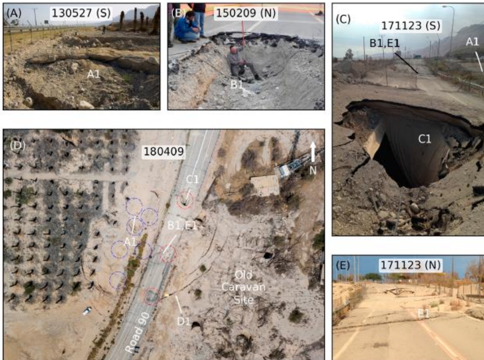
Joonis 3.11 [22] Kuupäevad on märgitud AAKKPP vaatega sulgudes olevas suunas. Aukude plaan on näha jooniselt D. Pildil A1 on lehter pärast kruusaga täitmist. B1 näitab geosüntetika nähtavale tulekut 5m laiuse ning 9m sügavuse õõnsuse peal. C1 näitab lehtri kokkuvarisemist teel pärast viite aastat InSari tuvastatud hoiatusest. D1 näitab ringikujulisi mõrasid, sinised ringid näitavad auke teemaa-alal ning punased ringid auke teel. E1 näitab survepingest tekkinud deformatsioone.
