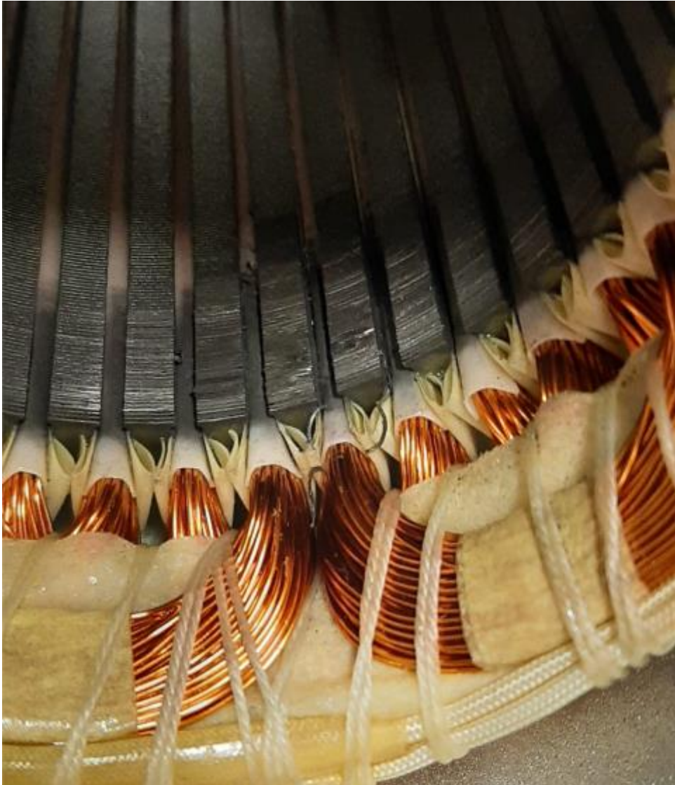
Pic 3. Katsestendi asünkroonmootori staatori kahjustus
