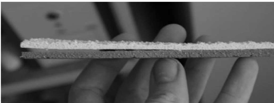
Joonis 10. Armeerimismördi ja viimistluskihi delamineerumine kliimatsüklite korral. (Liisma et al., 2015)
