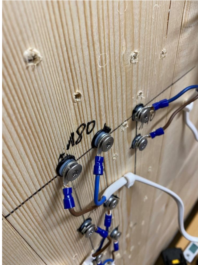
Joonis 32. Lõplikult paigaldatud, mastiksiga isoleeritud elektrod kruvid. (Testmaja pildikogu, 2023)
