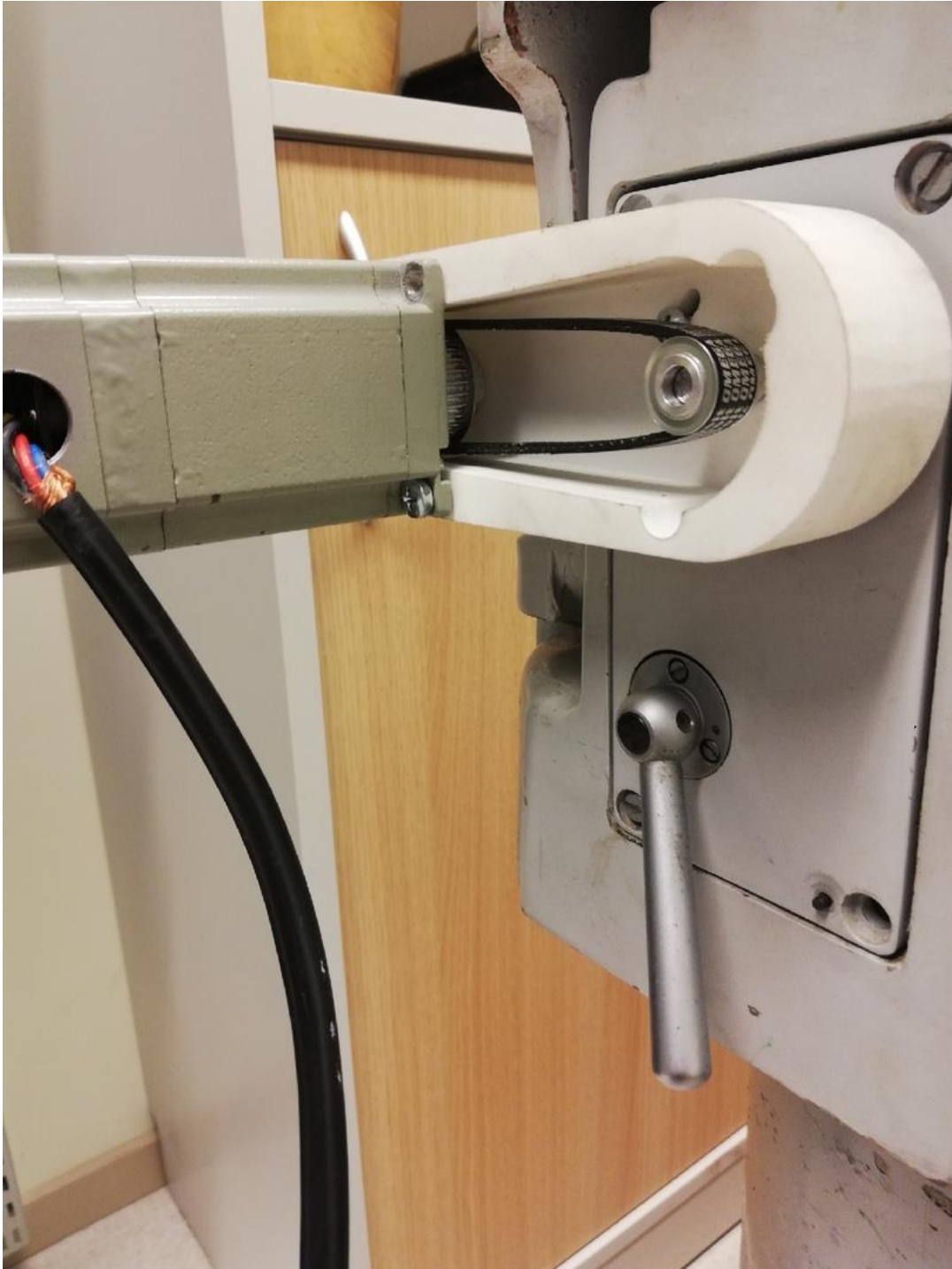
Joonis 3. See on lõppes kostatud mikroskoobi laua ajam
