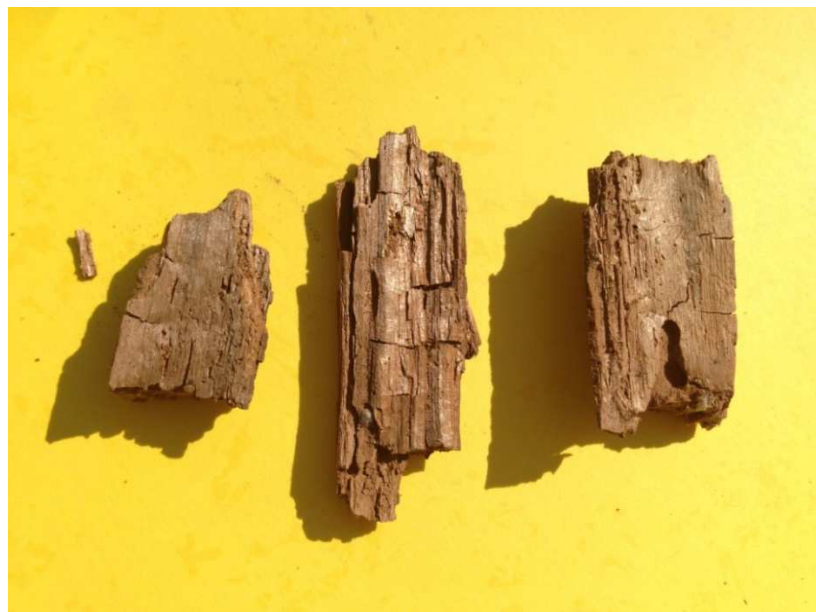
Joonis 4.1. Pruunmädanikukahjustusega proovitükid vahelaetaladest
