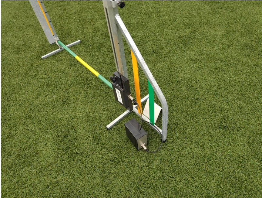
Joonis 2. Konkurendi ajavõtusüsteem. Pildilt on näha eraldi toiteplokki ja spetsiaalseid takistuse poste. Martti Vaidla 2020
