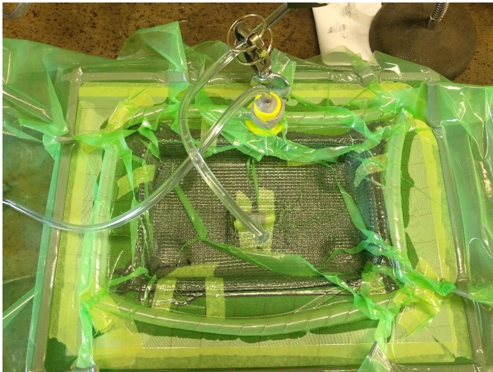
Joonis 8.6 Korpuse valmistamine vaigu infusiooni meetodil
