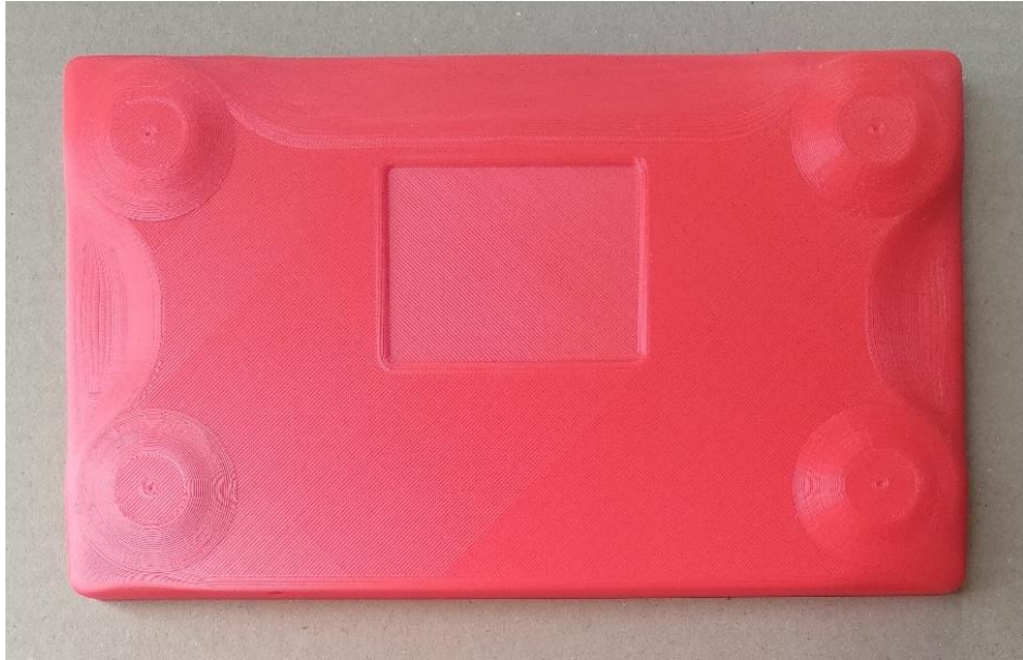
Joonis 8.2 3D prinditud korpuse mudel
