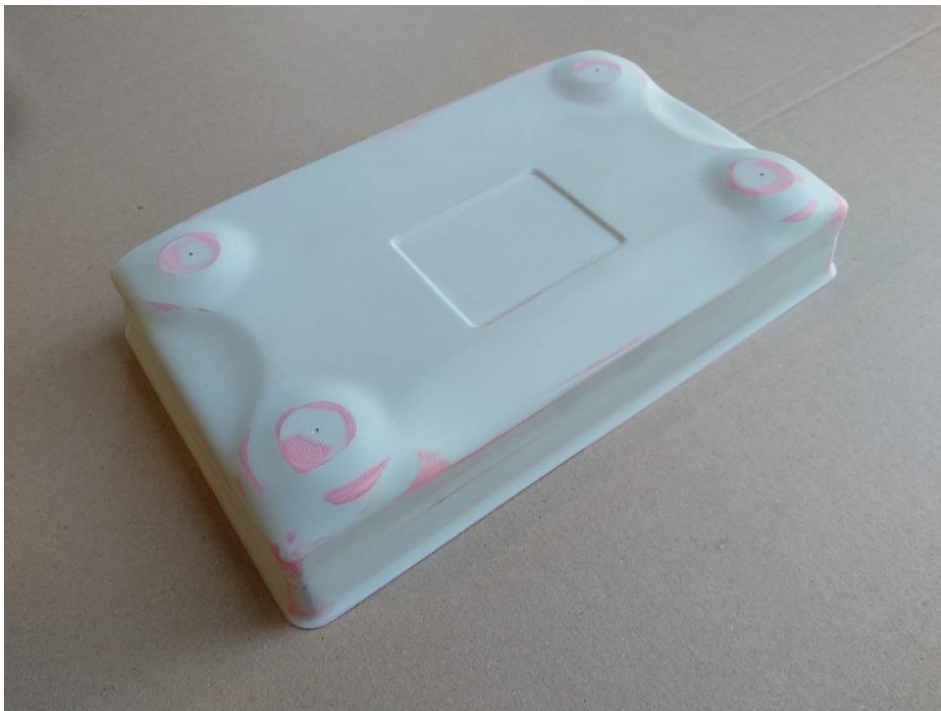
Joonis 8.3 Pahteldatud ja krunditud korpuse mudel
