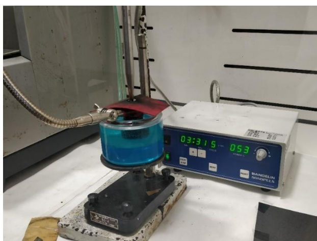
Joonis 5: Ultraheli segisti seadmed ning protsessi ülesehitus.
