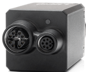
Joonis 3.2 Triton 2.3 MP Mudel a) tagant vaade b) eest vaade ilma objektiivita [22]
