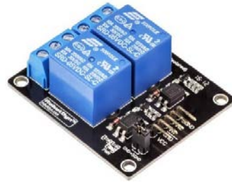
Joonis 3.10 a) Isereguleeriv kütteelement HP06 [49] ning b) releemoodul kütte lülitamiseks [50]
