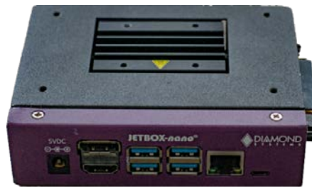
Joonis 3.1 Jetson Nano arendaja komplekt JETBOX korpuses [11][12]
