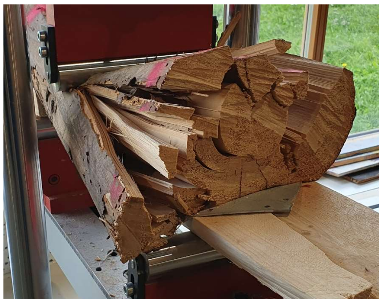
Joonis 19. Katsekeha purunemine
