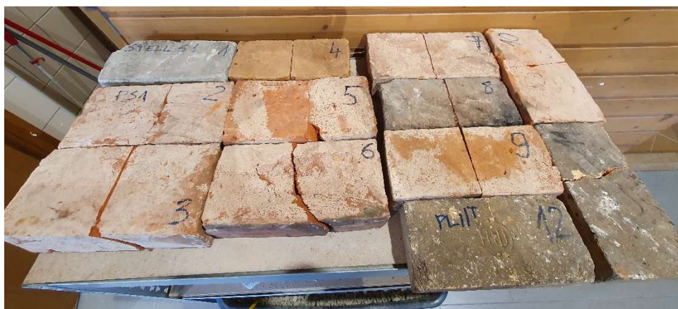
Joonis 25. Foto katsekehadest peale paindetugevuse katset
