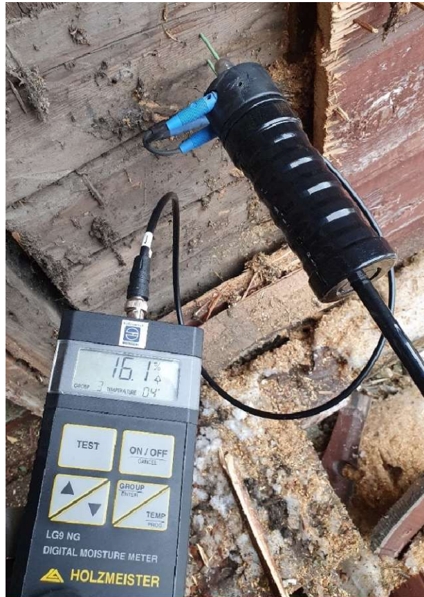
Joonis 17. Foto seadmest LG9-NG ning palgi niiskussisalduse mõõtmisest
