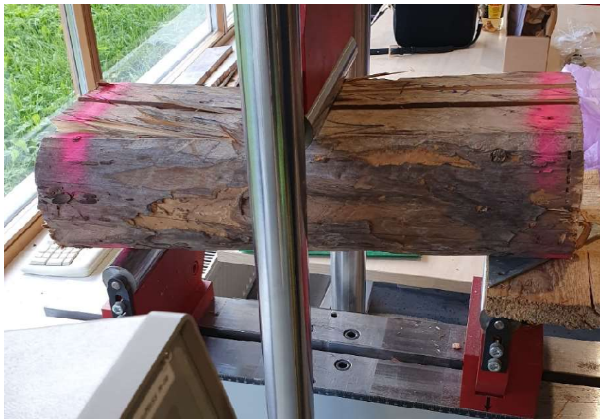
Joonis 18. Katsekeha sätitud masinale paindetugevuse testiks
