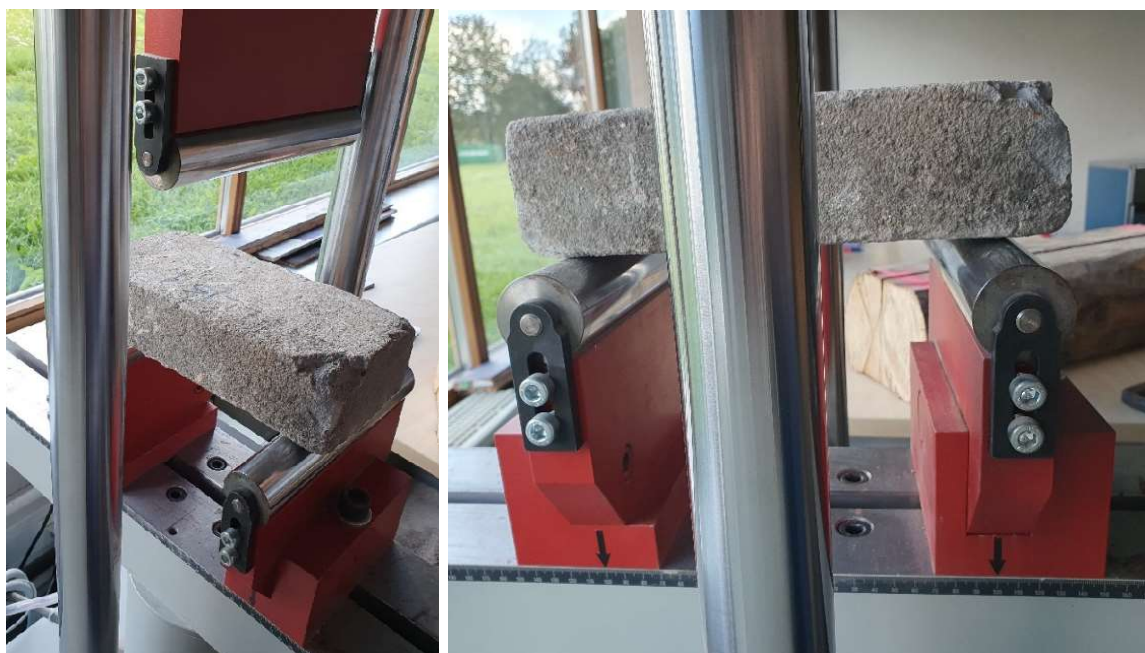
Joonis 24. Katsekeha sätitud masinale paindetugevuse testiks
