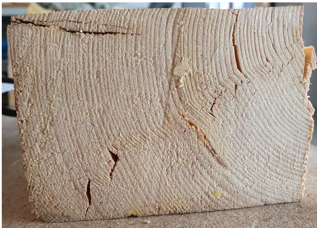
Joonis 21. Puidust katsekeha purunemispilt
