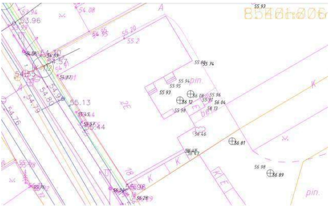
Joonis 3. Vee- ja kanalisatsioonitorustike plaan
