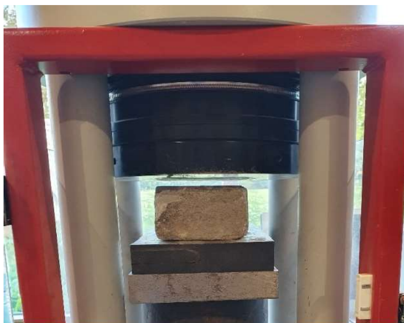
Joonis 26. Katsekeha säitud masinasse survetugevuse testiks
