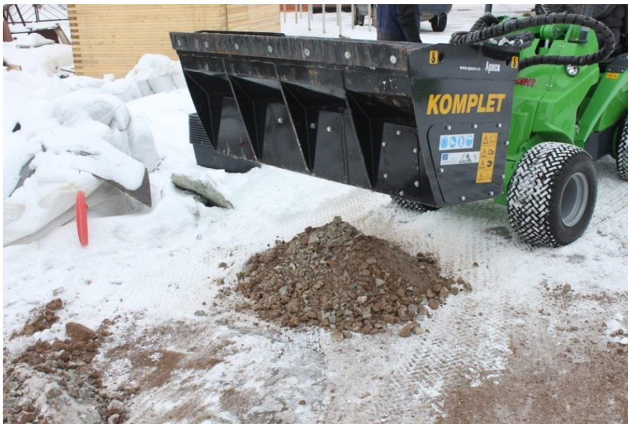
Joonis 15-8 Kiviõli Keemiatööstuse aheraine purustamise katsed
