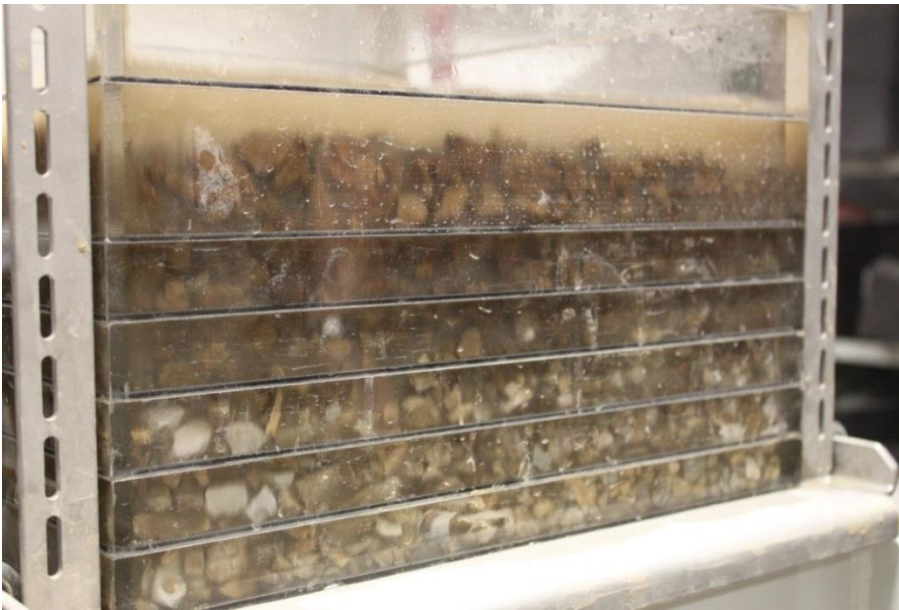
Joonis 15-9 Estonia põlevkivikaevanduse põlevkivi märgsepareerimine
