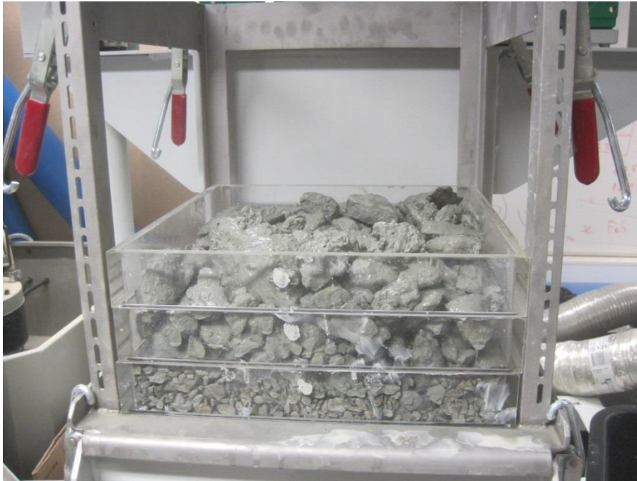
Joonis 15-10 Paekivitoodete Tehase kaevise separeerimiskatsed
