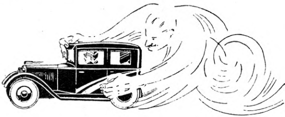
Joon. 4. Siin on sümboliseeritult kujutatud auto taha tekkivate õhukeeriste takistavat mõju auto edasiliikumisele.
