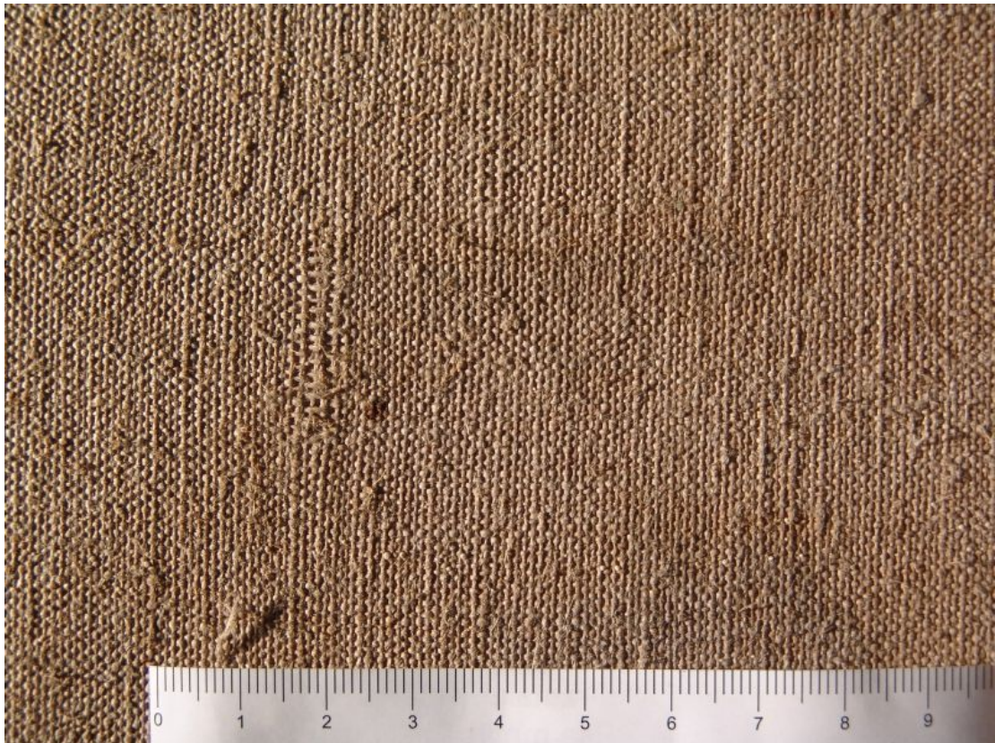
Foto 27.3. Lõuendi kahjustunud piirkond, kust on võetud kiuproov SEM-is uurimiseks
