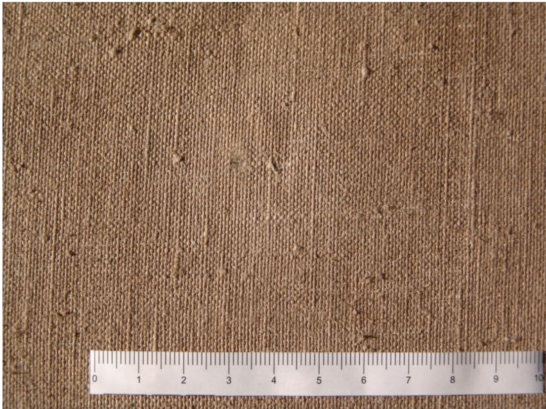
Foto 13.3. Lõuendi kahjustunud piirkond, kust on võetud kiuproov SEM-is uurimiseks
