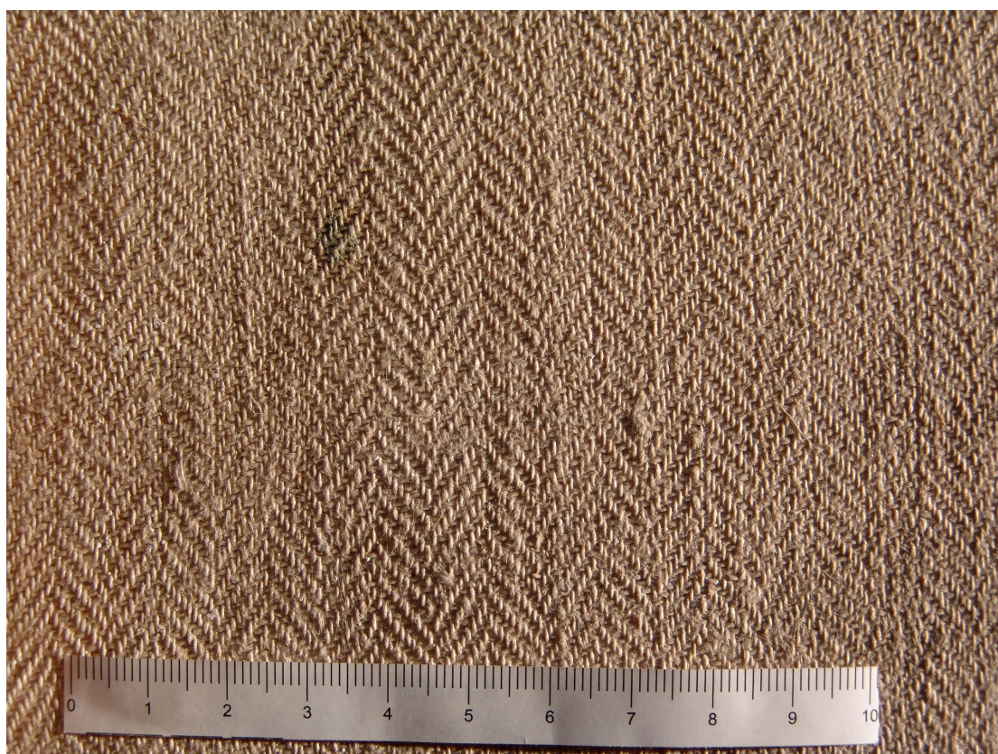
Foto 16.3. Lõuendi kahjustunud piirkond, kust on võetud kiuproov SEM-is uurimiseks
