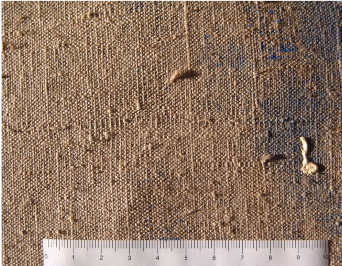
Foto 24.3. Lõuendi kahjustunud piirkond, kust on võetud kiuproov SEM-is uurimiseks
