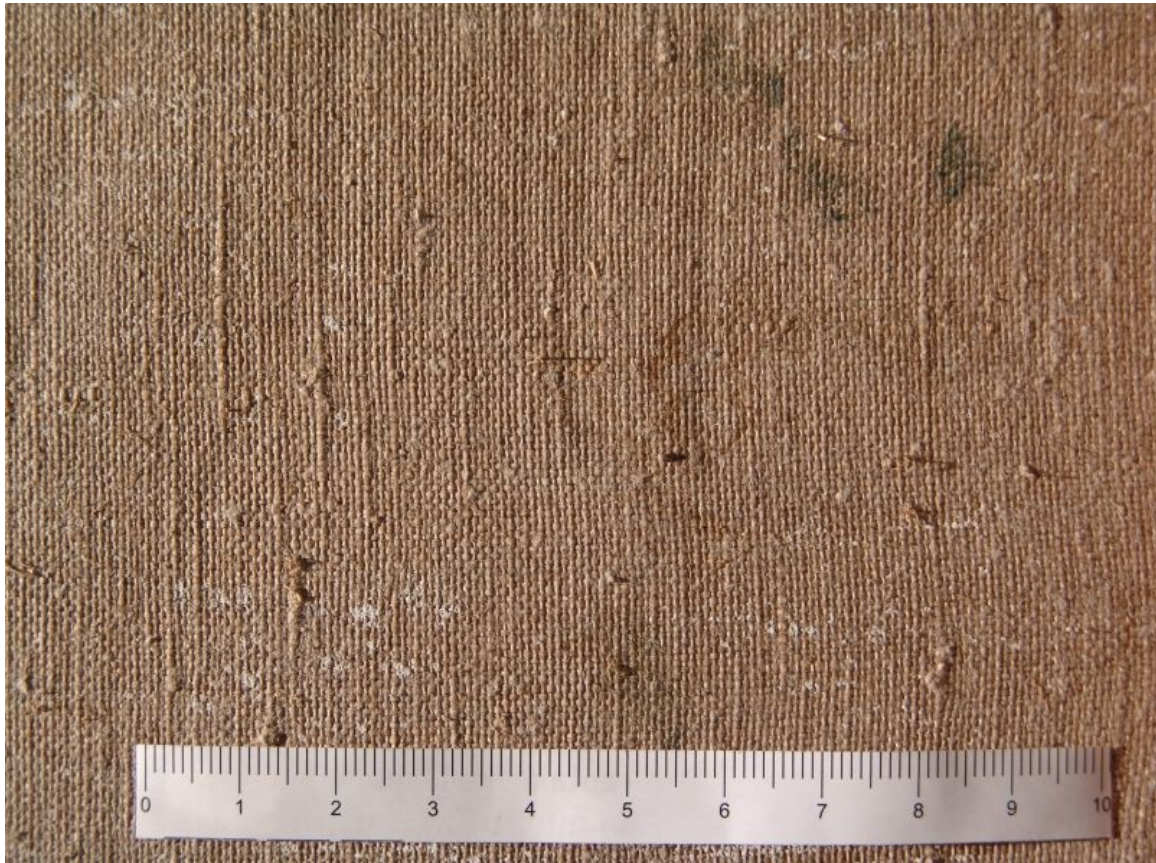
Foto 11.3. Lõuendi kahjustunud piirkond, kust on võetud kiuproov SEM-is uurimiseks
