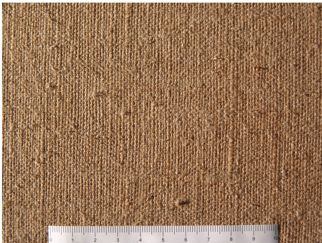
Foto 20.3. Lõuendi kahjustunud piirkond, kust on võetud kiuproov SEM-is uurimiseks
