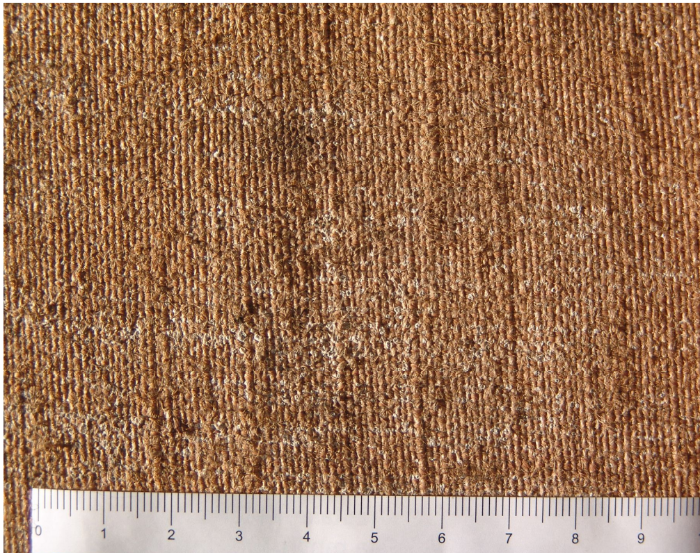
Foto 26.3. Lõuendi kahjustunud piirkond, kust on võetud kiuproov SEM-is uurimiseks
