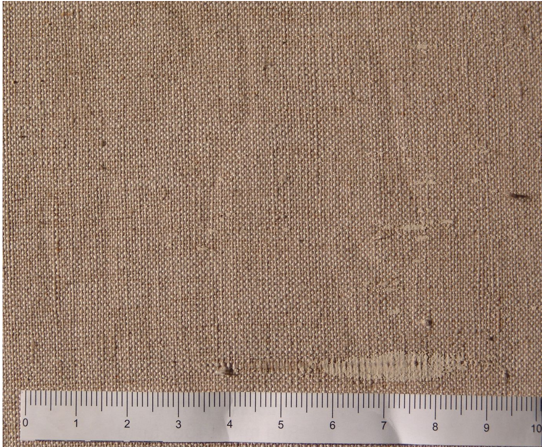
Foto 17.3. Lõuendi kahjustunud piirkond, kust on võetud kiuproov SEM-is uurimiseks
