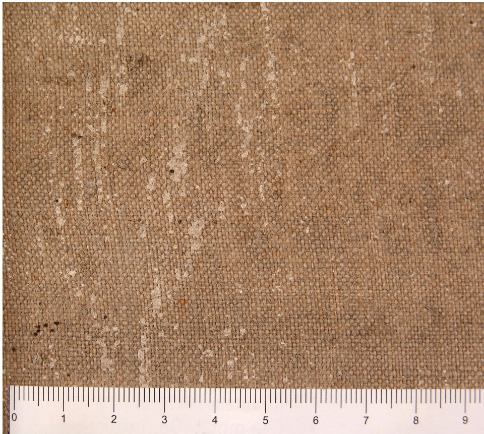
Foto 12.3. Lõuendi kahjustunud piirkond, kust on võetud kiuproov SEM-is uurimiseks
