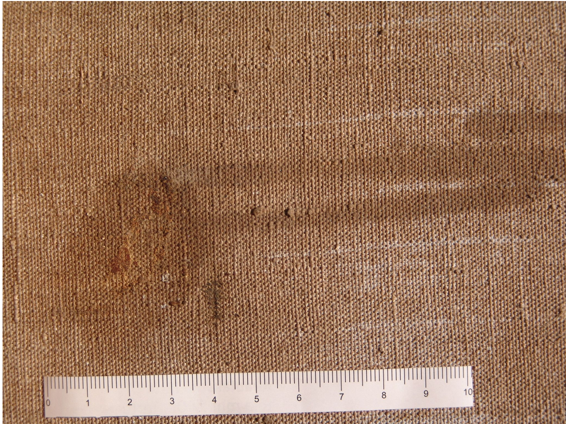
Foto 25.3. Lõuendi kahjustunud piirkond nr 1, kust on võetud kiuproov SEM-is uurimiseks
