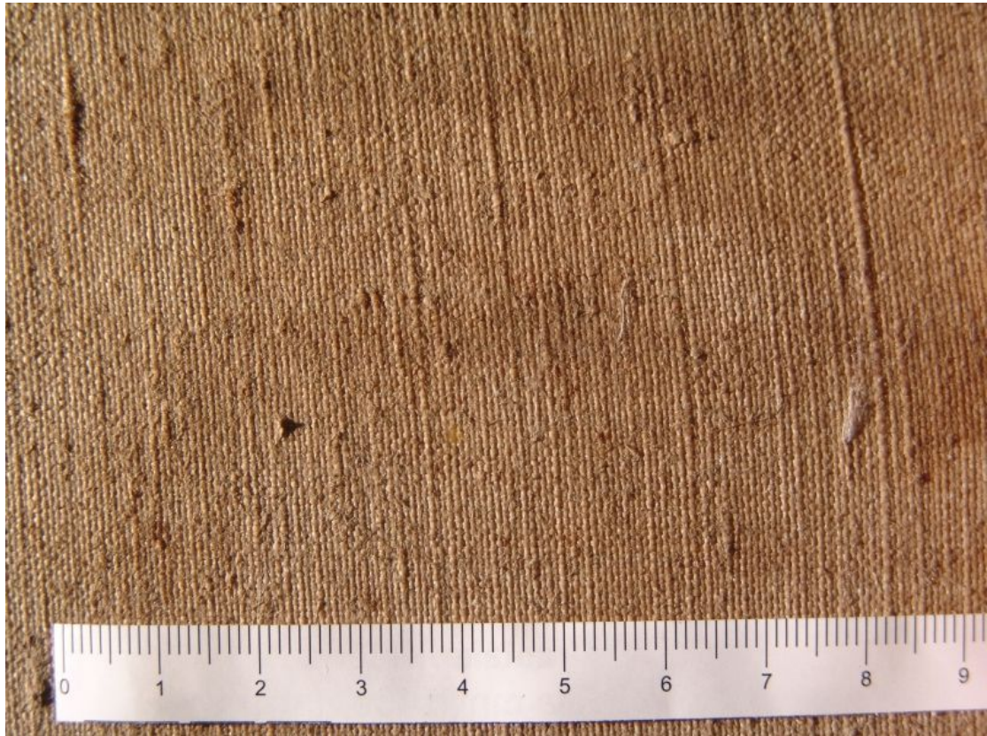
Foto 3.3. Lõuendi kahjustunud piirkond, kust on võetud kiuproov SEM-is uurimiseks
