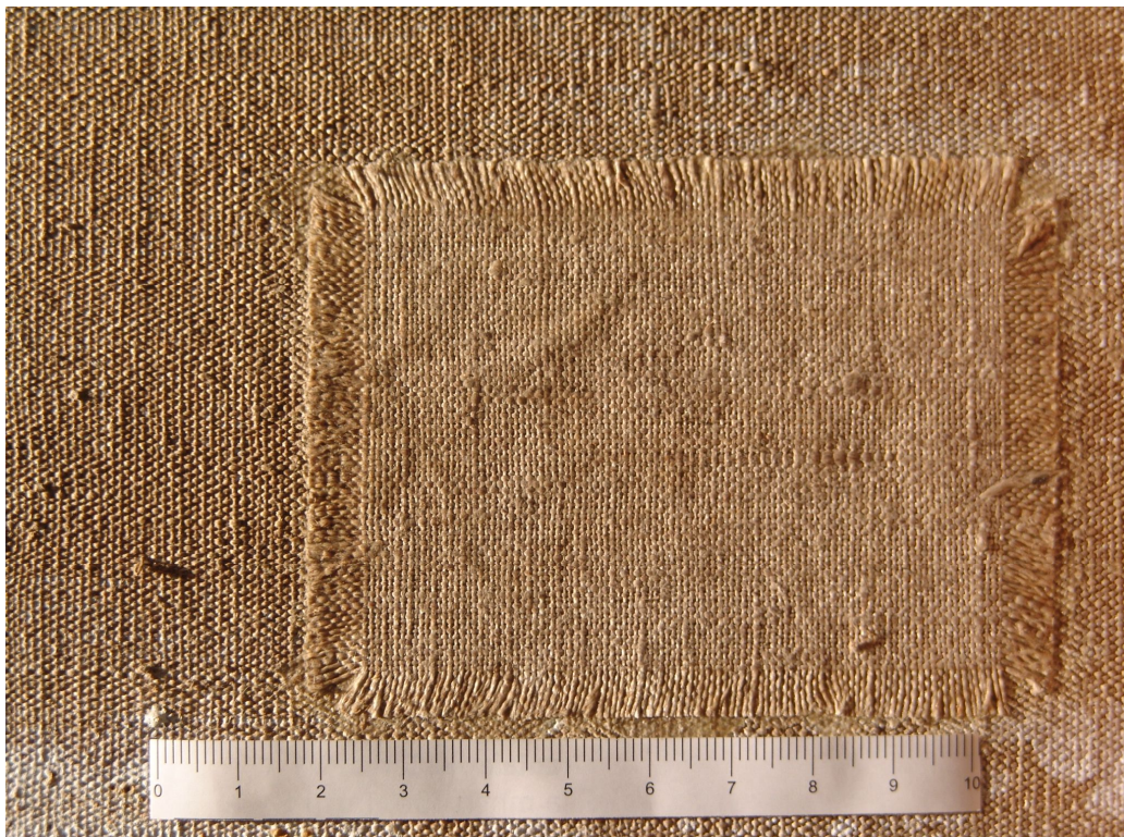
Foto 25.4. Lõuendi kahjustunud piirkond, kust on võetud paiga proov kiu tuvastamiseks
