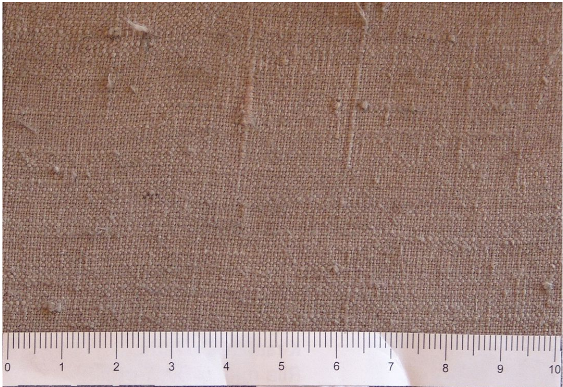
Foto 6.3. Lõuendi kahjustunud piirkond, kust on võetud kiuproov SEM-is uurimiseks
