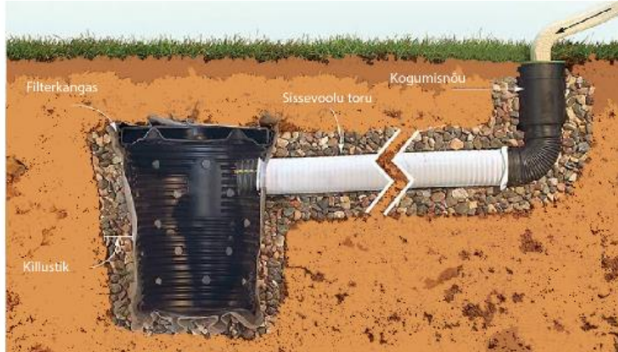
Skeem 11. Imbkaevu skemaatiline läbilõige (allikas: The family Handyman )
