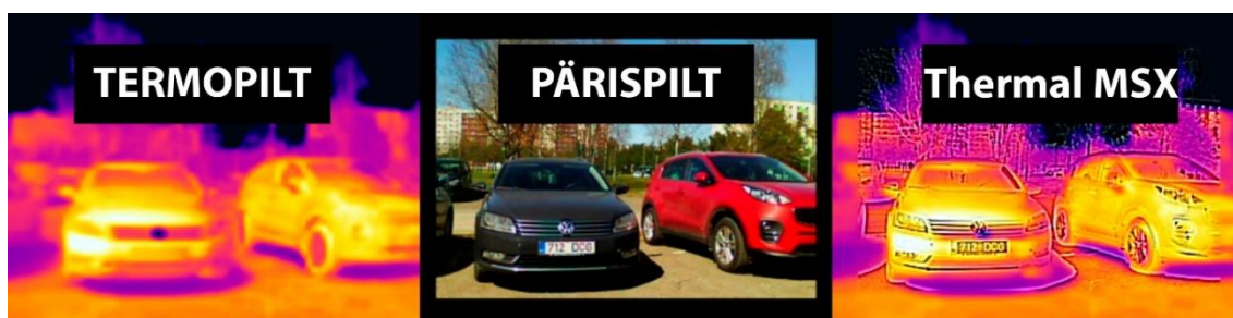
Joonis 15. Näidised termopildist, pärispildist ja kombineeritud termopildist ( Thermal MSX ).
