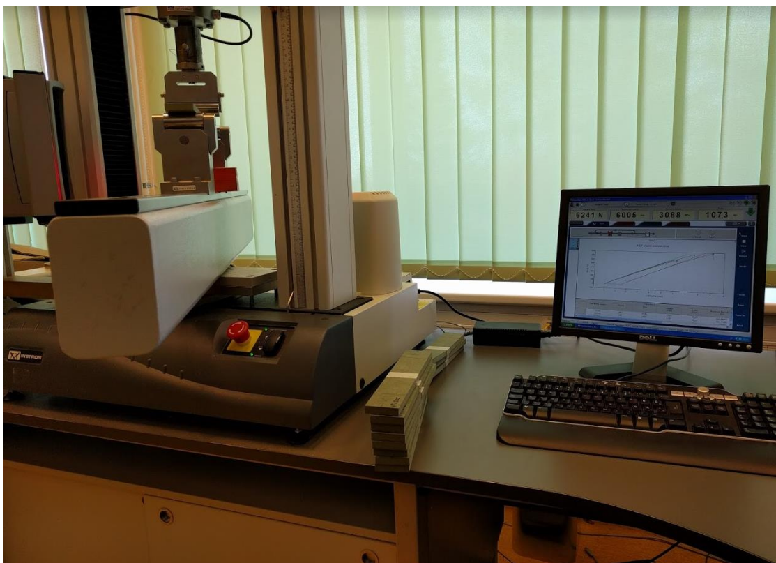
Joonis 2.1 Universaalne katseseade INSTRON 3369 ja optiline videotensomeeter INSTRON 2663.281
