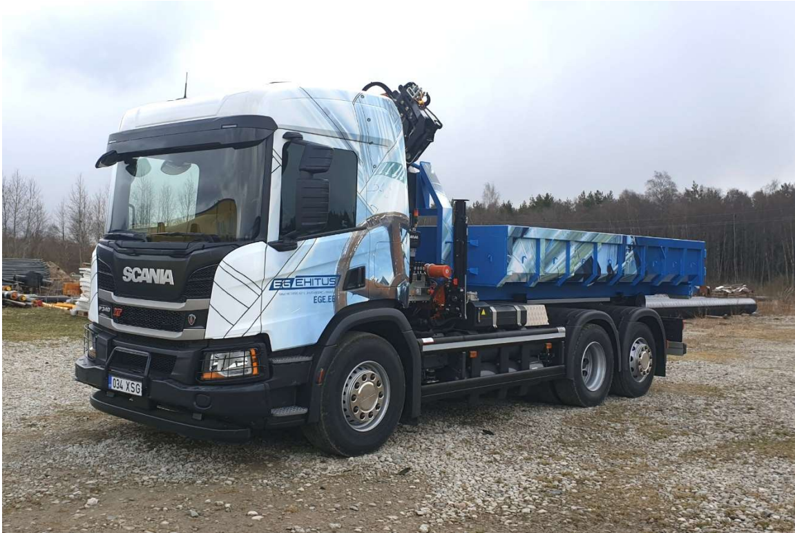
Joonis nr 24. Scania P340 gaasimootoriga veoauto. Foto: autori erakogu.
