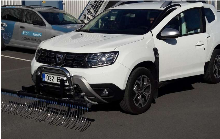
Joonis nr 28. Auto külge kinnitatav gaasidetektor Selma. [62]
