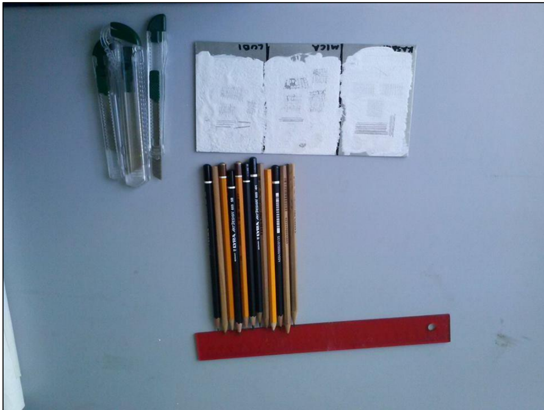
Joonis 2 – Kõvaduse katse näidis ja töövahendid. Autori tehtud pilt.
