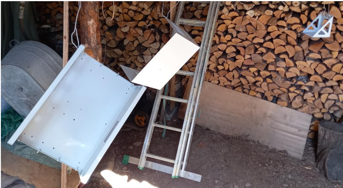
Joonis 2.41: Kere detailid värvimise ajal. Detailid on riputatud lakke, et võimaldada ligipääsu iga detaili kõigile külgedele üheaegselt
