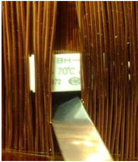
Joonis 2.4: Termos- taatlüliti mähise keerdude vahel
