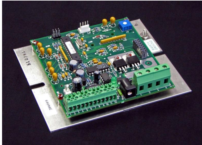
Sele 4.7 TC-48-20 kontrolleri korpuseta OEM konfiguratsioonis
