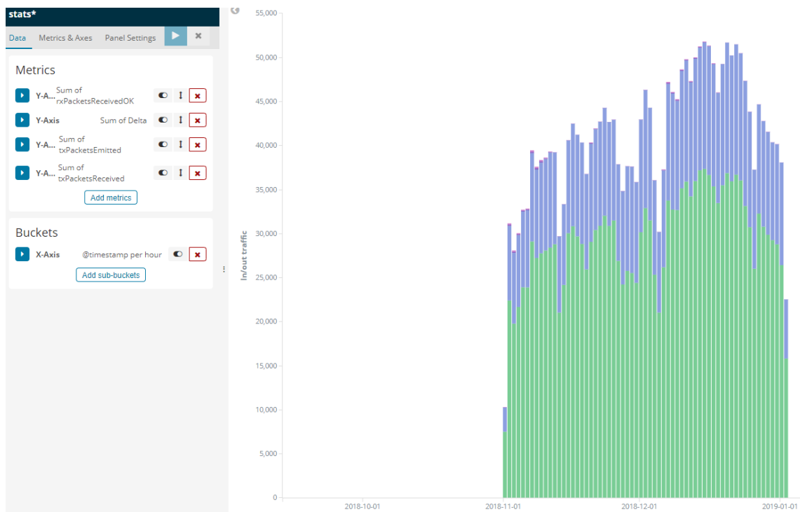
Joonis 22. LoRa võrgukoormuse Vertical Bar ühe tunni täpsusega
