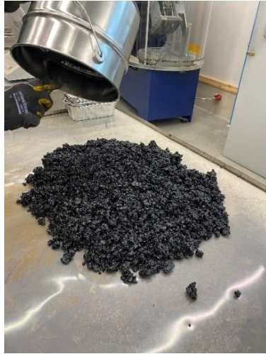
Joonis 3.1 AC 20 base segu jagamine proovikehade valmistamiseks [autori erakogu]
