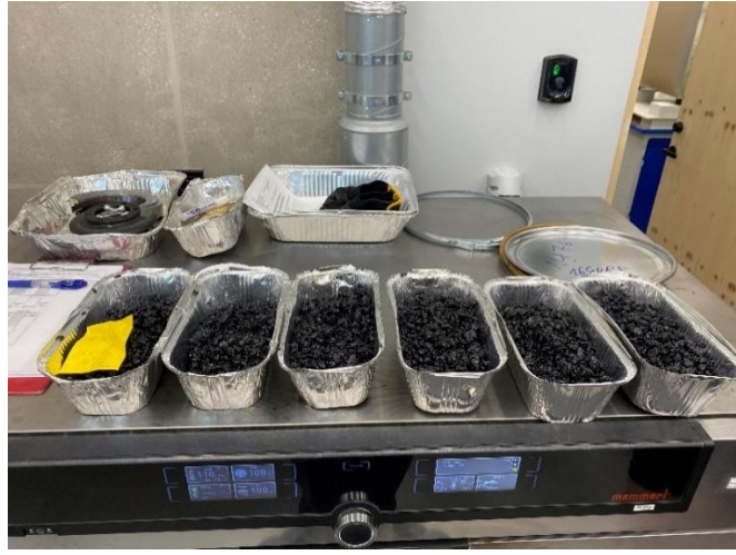
Joonis 3.1 AC 20 base segu jagamine proovikehade valmistamiseks [autori erakogu]
