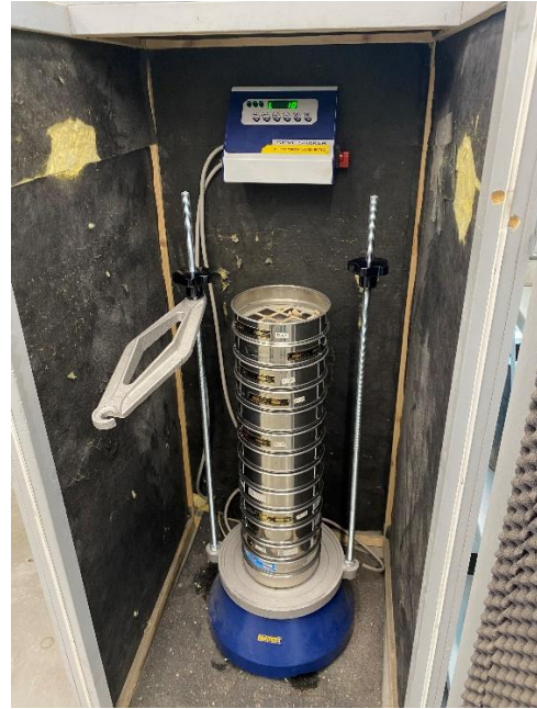
Joonis 3.4 Täitematerjali sõelumine ekstraheerimise järgselt [autori erakogu]
