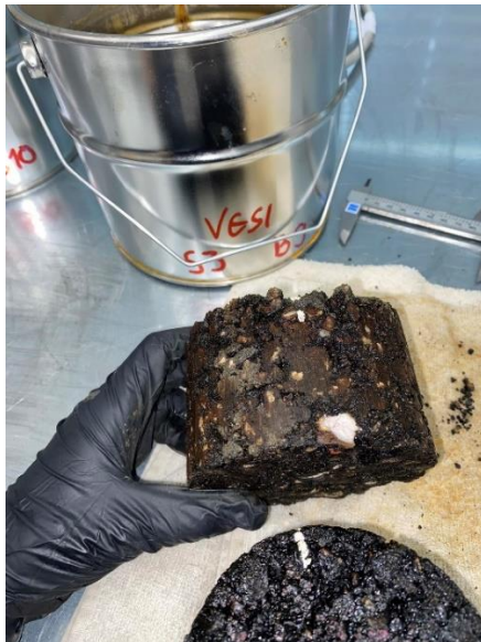
Joonis 4.10 Näiteid täitematerjali purunemist külmumis-sulamis tsüklite järgselt [autori erakogu]
