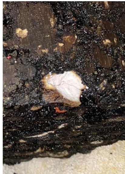
Joonis 4.10 Näiteid täitematerjali purunemist külmumis-sulamis tsüklite järgselt [autori erakogu]
