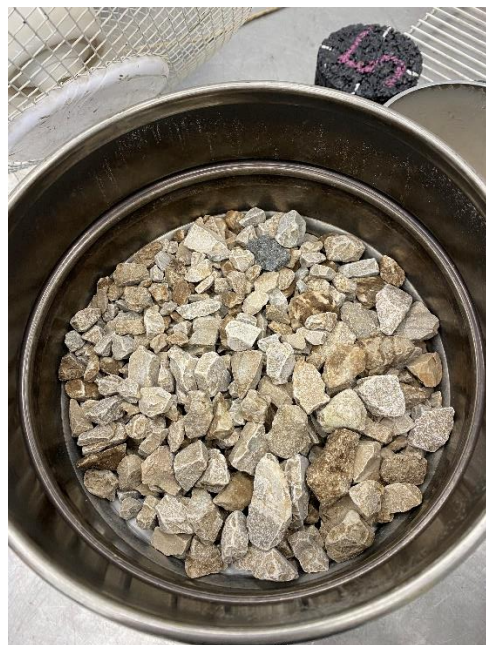
Joonis 3.3 Asfaltsegust sideaine ekstraheerimine [autori erakogu]
