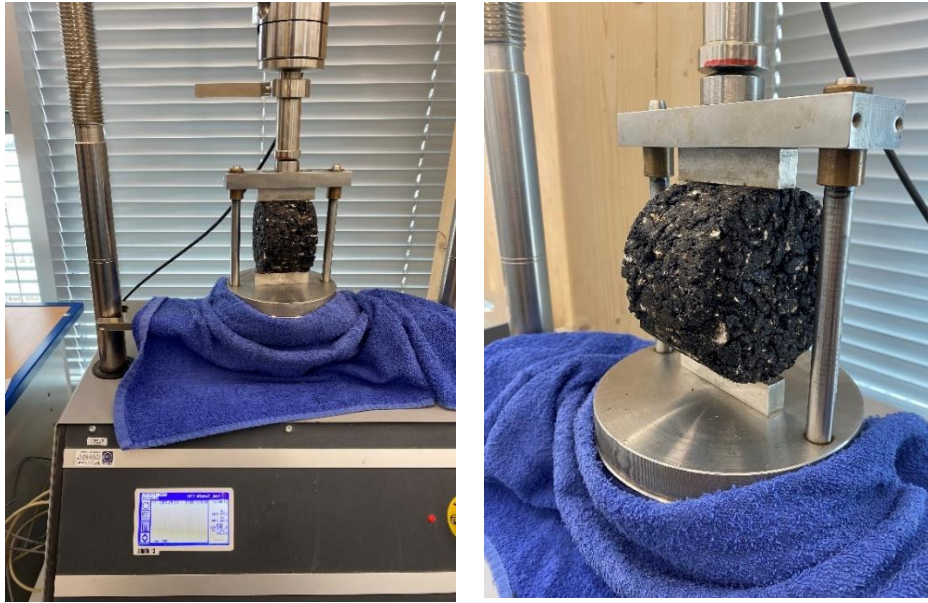
Joonis 3.5 Kaudne tõmbetugevuskatse AC 20 base katsekehale [autori erakogu]
