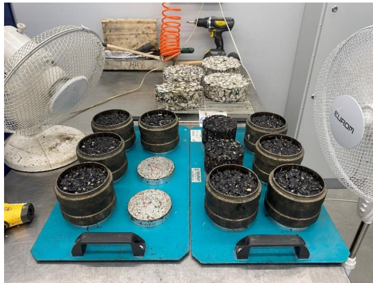
Joonis 3.1 AC 20 base segu jagamine proovikehade valmistamiseks [autori erakogu]
