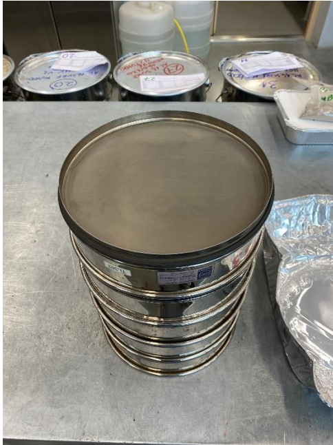
Joonis 3.4 Täitematerjali sõelumine ekstraheerimise järgselt [autori erakogu]
