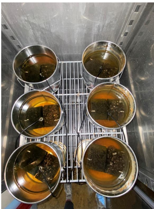
Joonis 4.6 Proovikehad kliimakambris külmumis-sulamistsükli lõppedes [autori erakogu]
