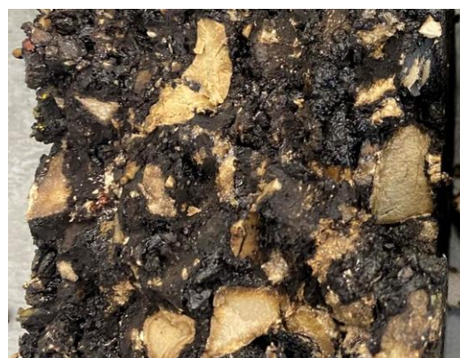
Joonis 4.11 AC 20 base proovikehade purunemine kaudse tõmbetugevuse katsel [autori erakogu]
