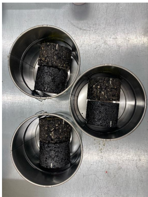
Joonis 3.7 Katsekehade paigutus anumates [autori erakogu]
