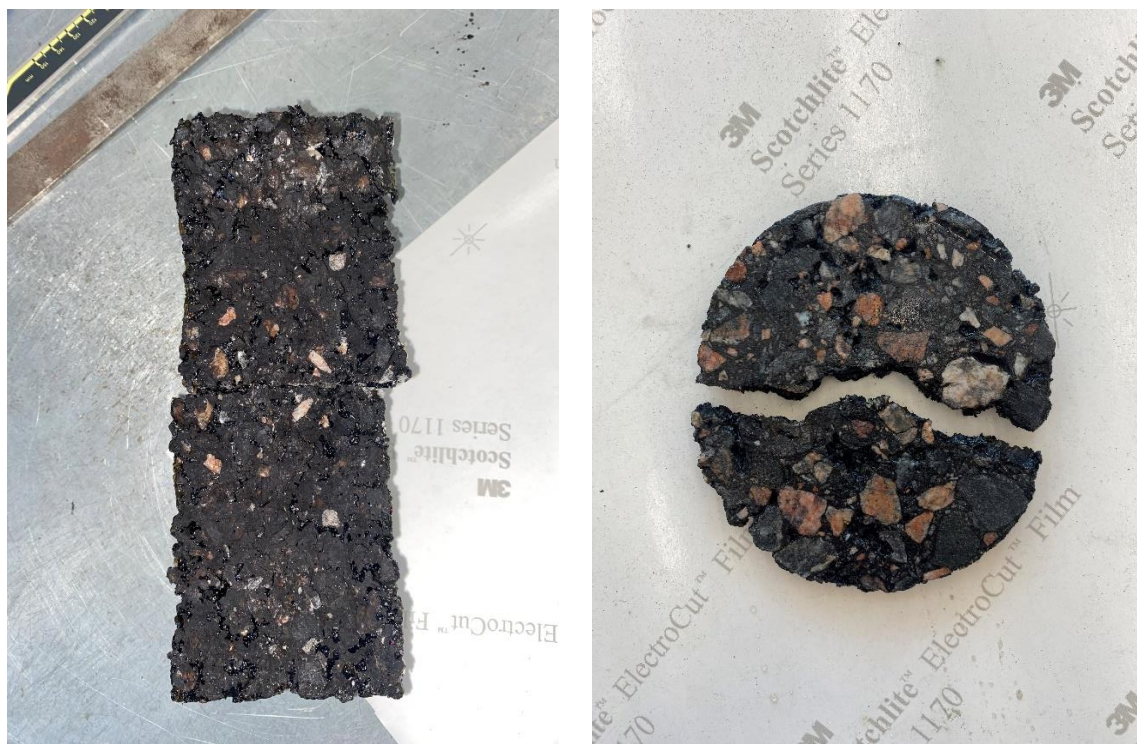
Joonis 4.8 AC 16 surf proovikeha purunemine kaudse tõmbetugevuse katsel [autori erakogu]
