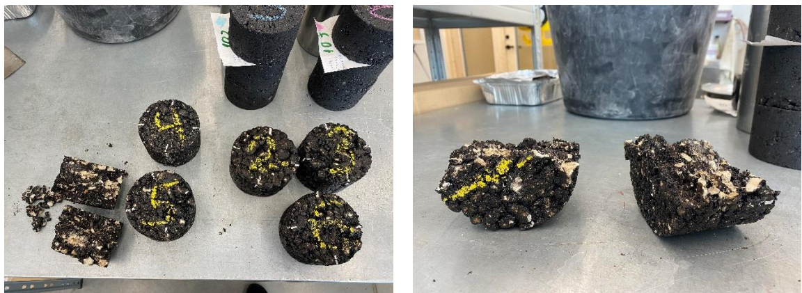
Joonis 3.6 AC 20 base proovikehad peale kaudse tõmbetugevuse katset [autori erakogu]
