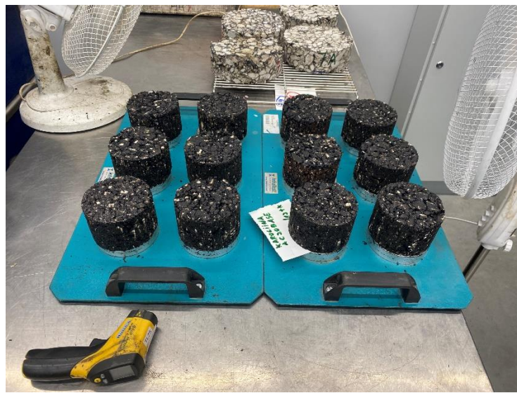
Joonis 3.2 Lööktihendajaga AC 20 base proovikehade valmistamine [autori erakogu]
