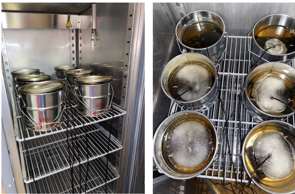
Joonis 3.9 Katsekehad kliimakambris [autori erakogu]
