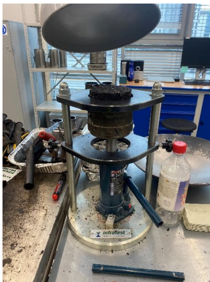
Joonis 3.2 Lööktihendajaga AC 20 base proovikehade valmistamine [autori erakogu]
