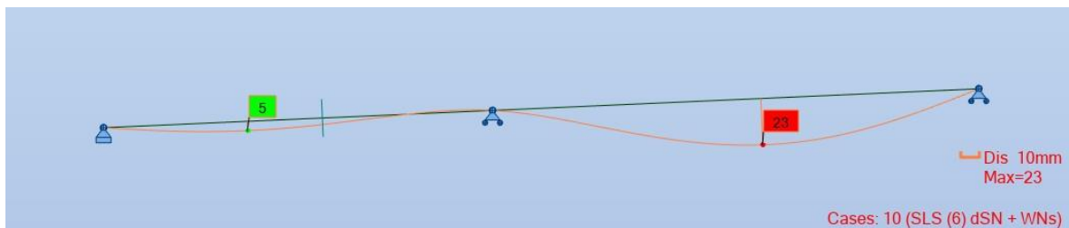
Joonis L7.4 Liimpuidust otsatala läbipaine SLS 6 olukorras
