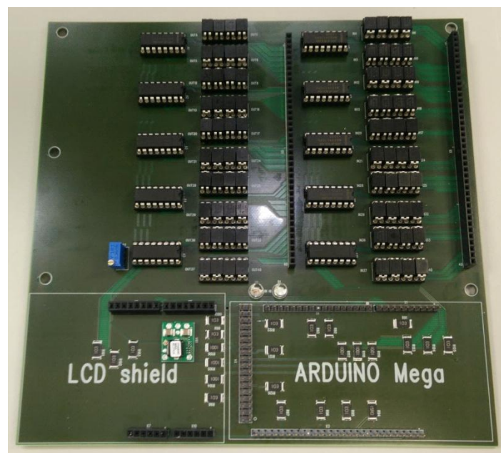
Joonis 7. Põhiplaadi ülemine külg, kus asuvad Arduino, LCD moodul, transistorid ja MUXid.
