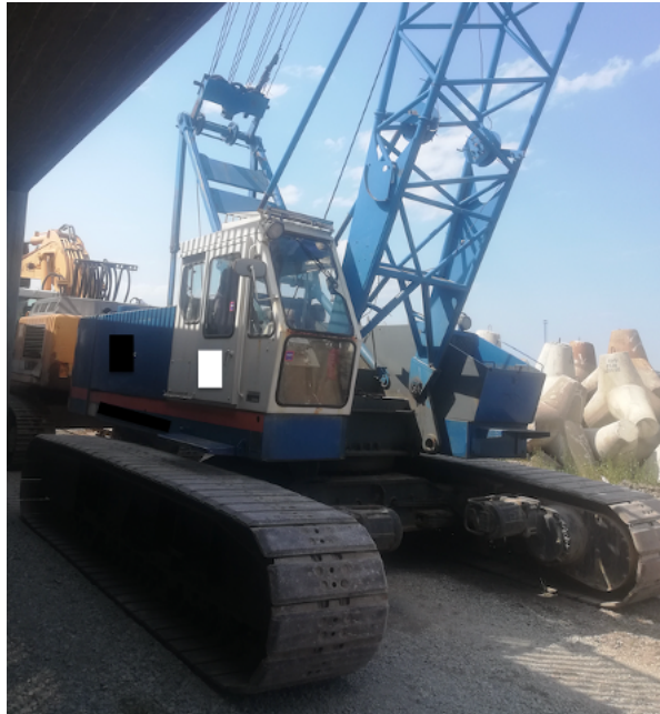
Foto 5.4 Kasutatav roomikkraana Hitachi 180-2 50T, erakogu
