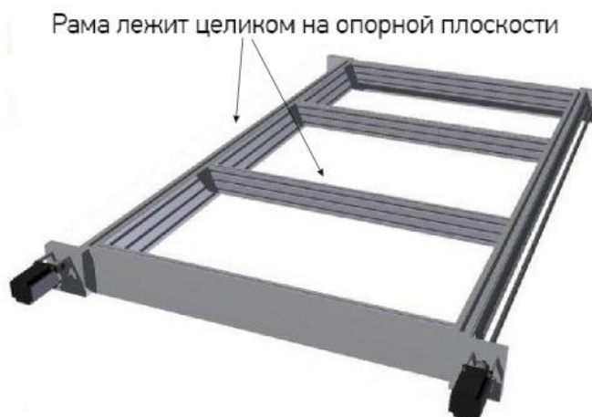
Рисунок 3.1 Станина с полной опорой и направляющие с полной опорой
