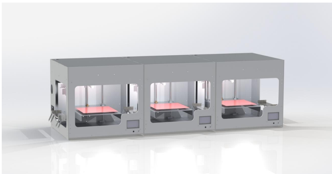
Рисунок 3.44 Три гибких производственных модуля, объединённых в производственную линию
