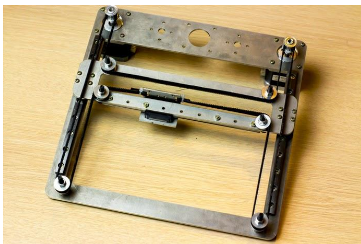
Рисунок 3.7 Пример сборки H-bot
