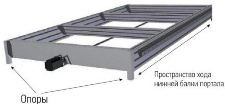
Рисунок 3.2 Станина с полной опорой по оси Y и частичной опорой по X
