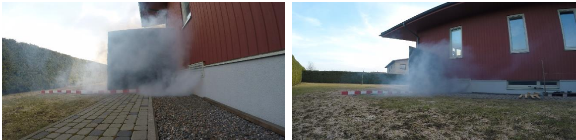
Joonis 3.3 RV 800x200 vaade küljelt ja diagonaalis. L=123 l/s, v=1,7 m/s, \Delta P=23 Pa
