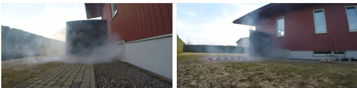
Joonis 3.4 RV 800x200 vaade küljelt ja diagonaalis. L=164 l/s, v=2,0 m/s, \Delta P=34 Pa
