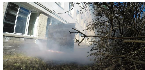
Joonis 3.12 YGC 250 vaade küljelt ja diagonaalis. L=164 l/s, v=4,3 m/s, \Delta P=28 Pa
