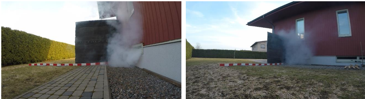
Joonis 3.2 RV 800x200 vaade küljelt ja diagonaalis. L=82 l/s, v=1,0 m/s, \Delta P=14 Pa
