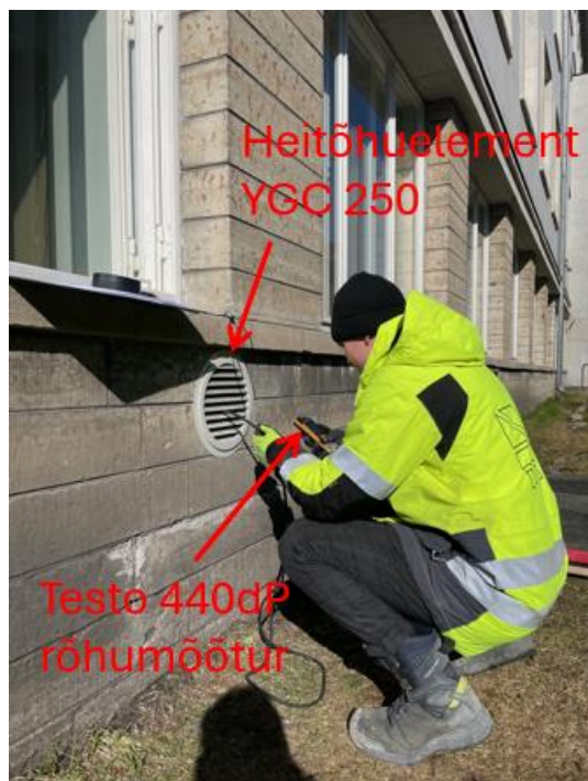
Joonis 2.16 Heitõhuelelementi rõhuvahe mõõtmine
