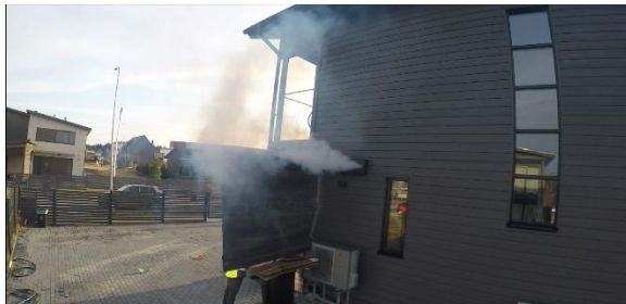
Joonis 3.8 RVD 200 vaade küljelt ja diagonaalis. L=83 l/s, v=7,0 m/s, \Delta P=46 Pa
