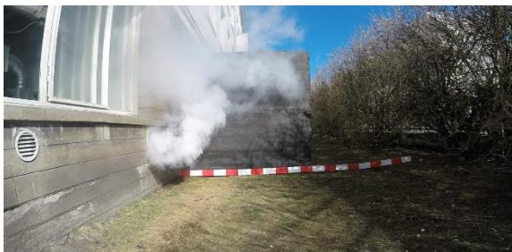
Joonis 3.9 YGC 250 vaade küljelt ja diagonaalis. L=41 l/s, v=0,8 m/s, \Delta P=2 Pa
