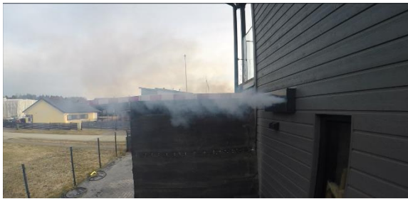
Joonis 3.8 RVD 200 vaade küljelt ja diagonaalis. L=83 l/s, v=7,0 m/s, \Delta P=46 Pa
