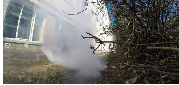
Joonis 3.10 YGC 250 vaade küljelt ja diagonaalis. L=82 l/s, v=2,0 m/s, \Delta P=7 Pa
