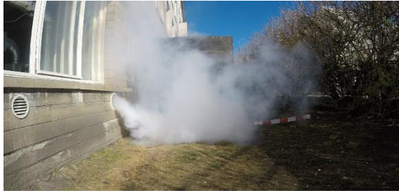
Joonis 3.10 YGC 250 vaade küljelt ja diagonaalis. L=82 l/s, v=2,0 m/s, \Delta P=7 Pa
