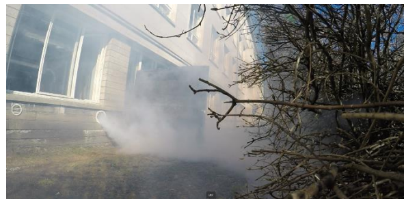
Joonis 3.11 YGC 250 vaade küljelt ja diagonaalis. L=123 l/s, v=3,3 m/s, \Delta P=20 Pa
