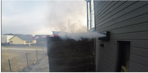
Joonis 3.7 RVD 200 vaade küljelt ja diagonaalis. L=62 l/s, v=4,9 m/s, \Delta P=15 Pa
