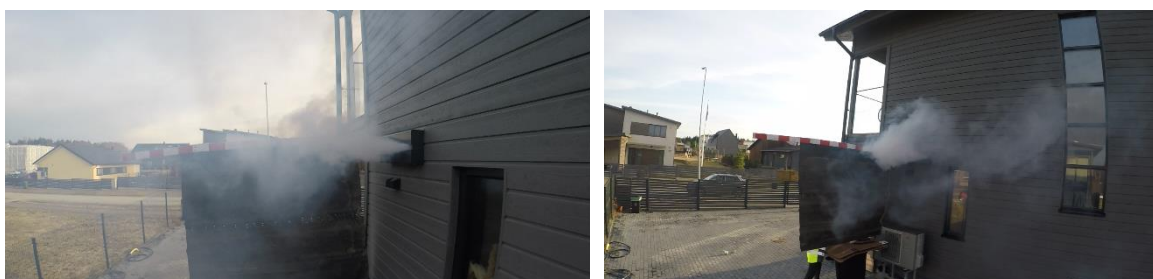
Joonis 3.6 RVD 200 vaade küljelt ja diagonaalis. L=42 l/s, v=2,8 m/s, \Delta P=4 Pa
