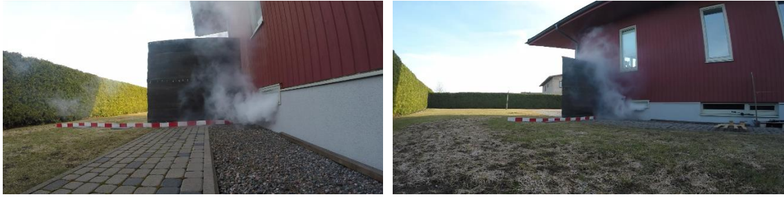
Joonis 3.1 RV 800x200 vaade küljelt ja diagonaalis. L=41 l/s, v=0,2 m/s, \Delta P=9 Pa
