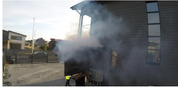
Joonis 3.7 RVD 200 vaade küljelt ja diagonaalis. L=62 l/s, v=4,9 m/s, \Delta P=15 Pa
