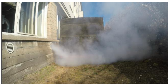
Joonis 3.12 YGC 250 vaade küljelt ja diagonaalis. L=164 l/s, v=4,3 m/s, \Delta P=28 Pa
