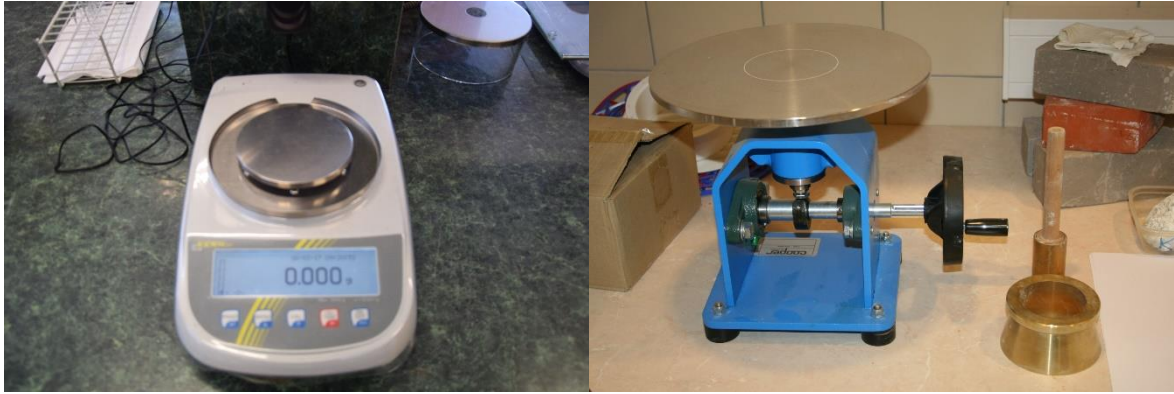
Joonis 3.2 Digitaalkaal Kern PLT 1200-3A ja Raputuslaud Cooper TCM-0060/E
