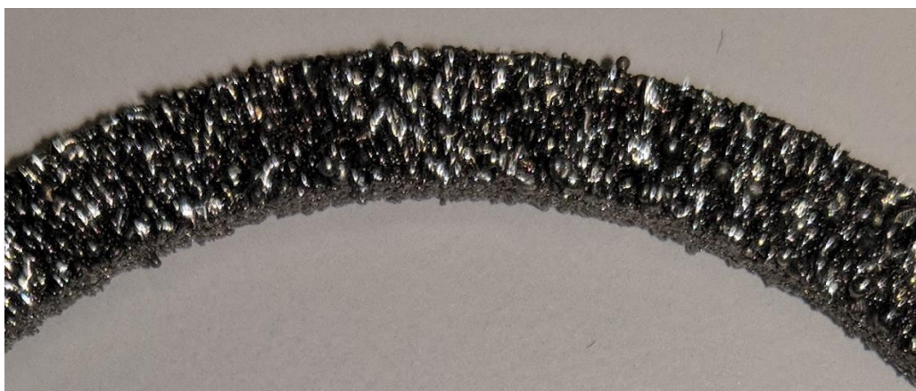
Joonis 4.7 Defektse keha välise struktuuri näidis
