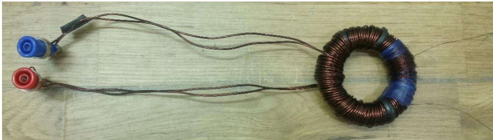
Joonis 4.2 Mähitud toroid ( 6,5% rännisisaldusega FeSi)
