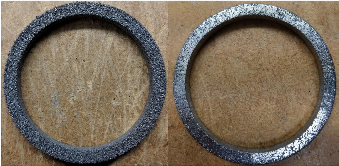
Joonis 4.1 Toroidi südamik enne ja pärast töötlemist ( FeSi rõngas)
