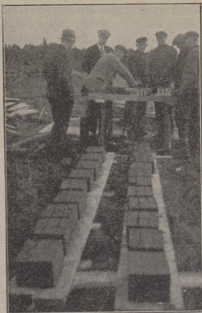
Joon. 24. Tsementkivide valmistamine 3-kivilise pressiga. Esiplaanil värsked kivid.
