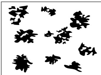
Joonis 4.7. Tempermalmi struktuur: a – mikrostruktuur, b – grafiidiosakeste kuju
