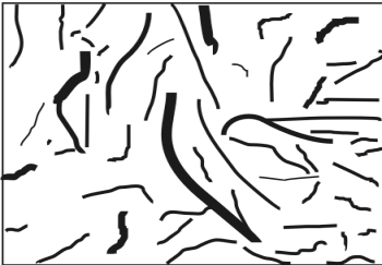
Joonis 4.5. Liblegrafiitmalmi struktuur: a – mikrostruktuur, b – grafiidi-osakeste kaju
