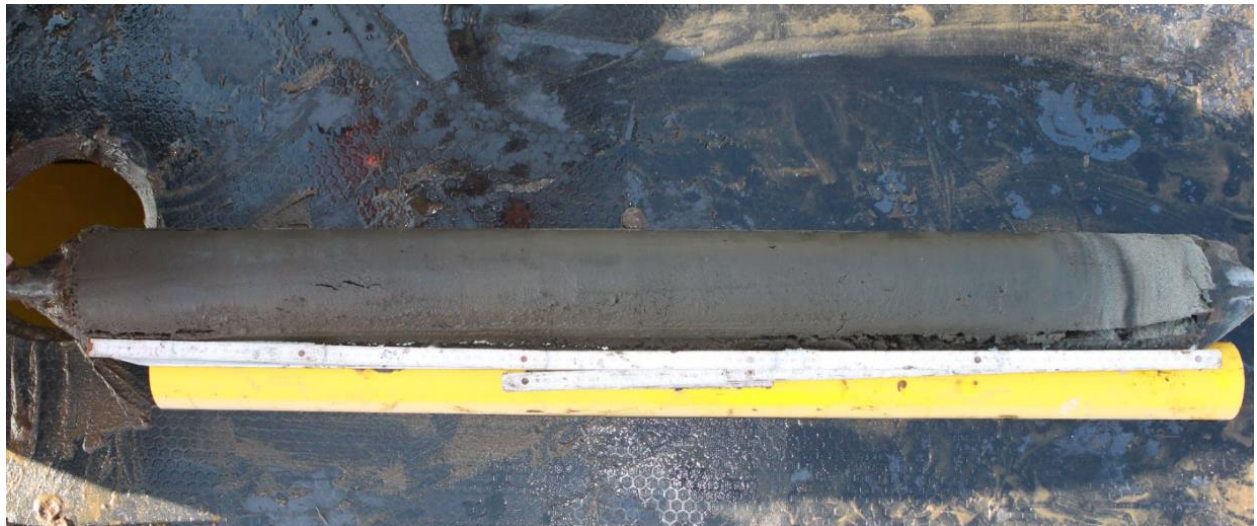
Joonis 10. Maardu järve setteläbilõike alumine osa puurkannus, nähtav on järvemuda, turba(mulla)kiht ning liiv.
