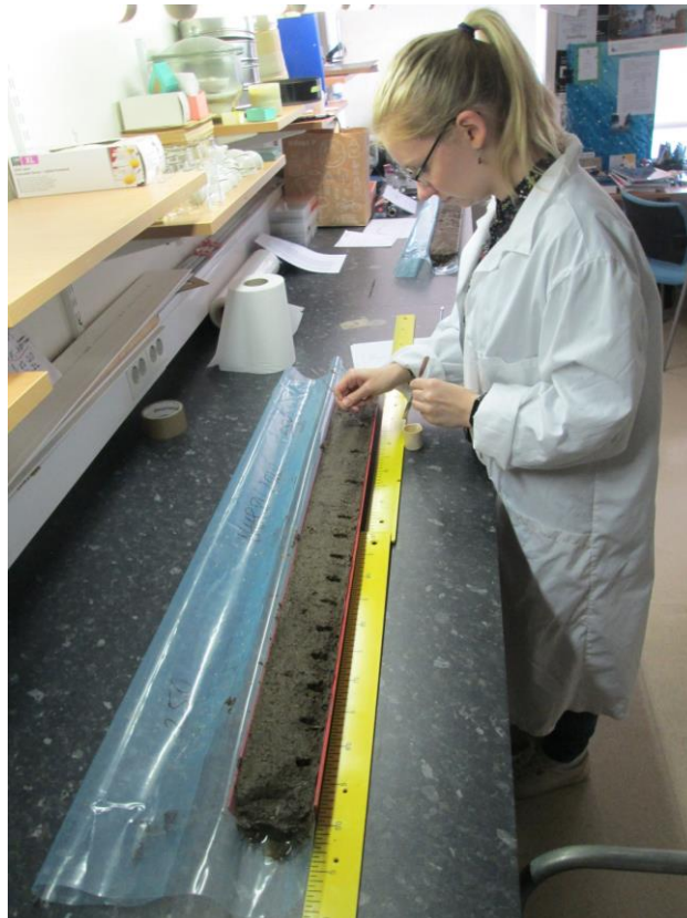
Joonis 4. Laboris proovide võtmine sette puursüdamikust.
