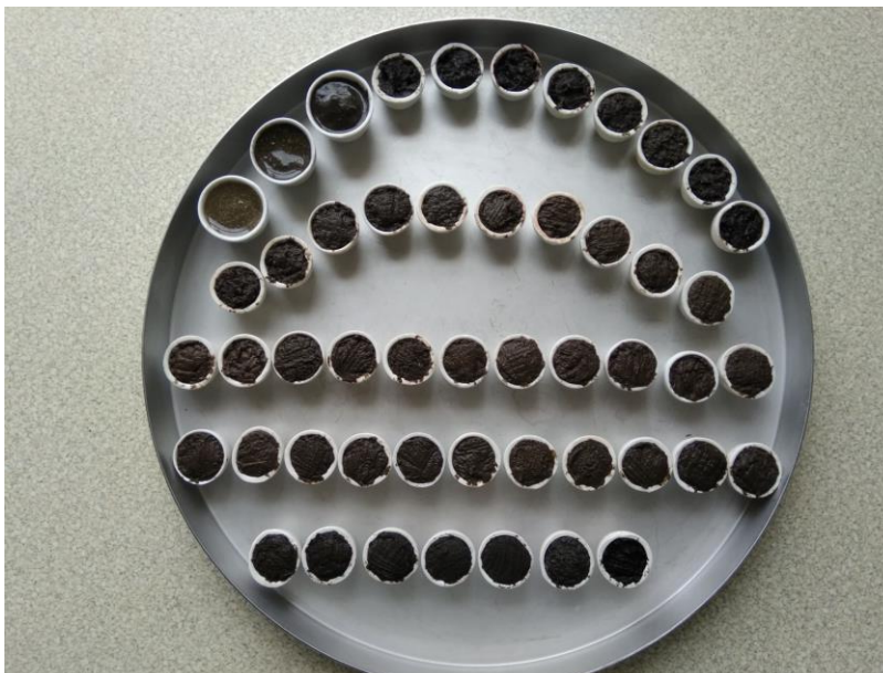
Joonis 6. Tiiglitesse asetatud setteläbilõike proovid.
