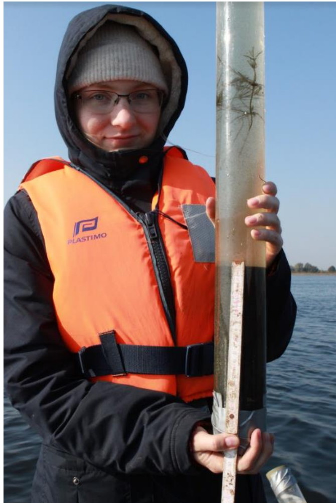
Joonis 3. Maardu järve setete ülemine osa Willneri setteproovivõtjas.
