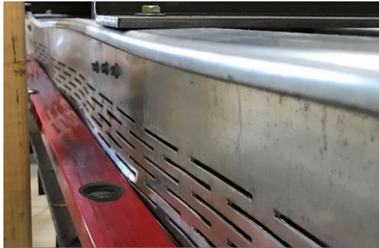
Joonis 4.11 Seinä välja mõlkumise lainesügavus
