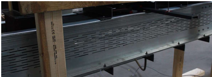
Joonis 4.5 Parempoolne profiil kui koormus on 27,9 kN
