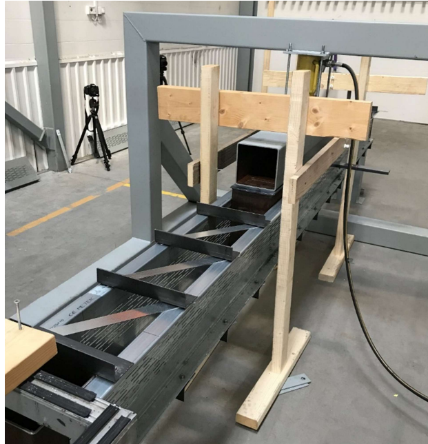
Joonis 3.21 Puidust raam siirdeandurite kinnitamiseks
