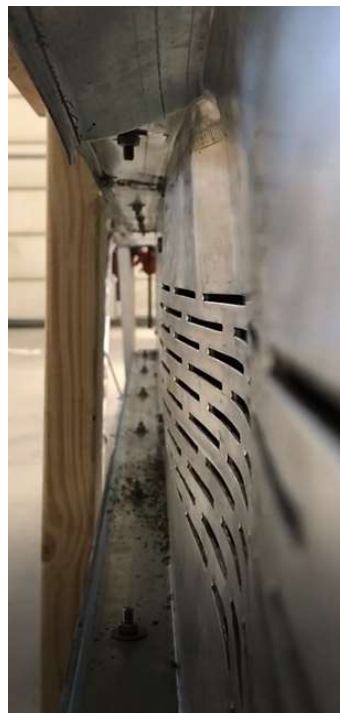
Joonis 4.17 Vasakpoolne profiil kaotatud kandevõimega
