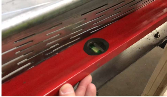
Joonis 4.10 Seinä välja mõlkumise lainesügavus
