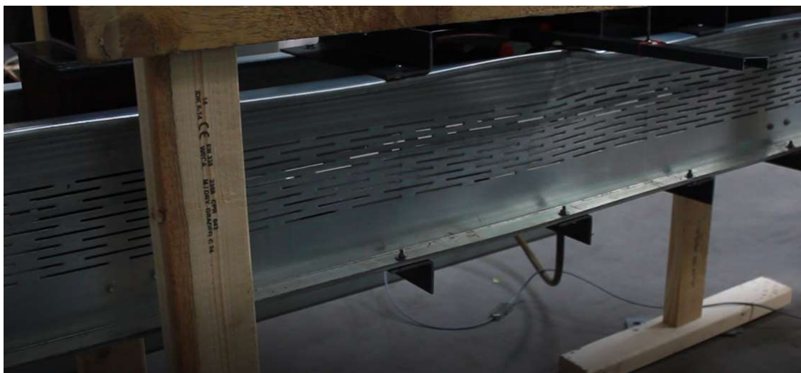
Joonis 4.18 Parempoolne profiil pärast koormuse eemaldamist
