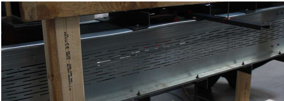
Joonis 4.7 Parempoolne profiil kui koormus on 30 kN
