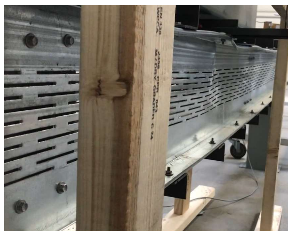
Joonis 4.15 Parempoolne profiil kaotatud kandeõimega
