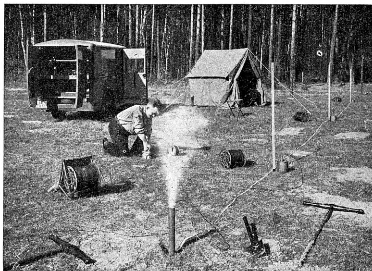
Joon. 7. Plahvatuslaengu süütamine. Valgete püstvaraste juures asetsevad maapinnal geofoonid.
