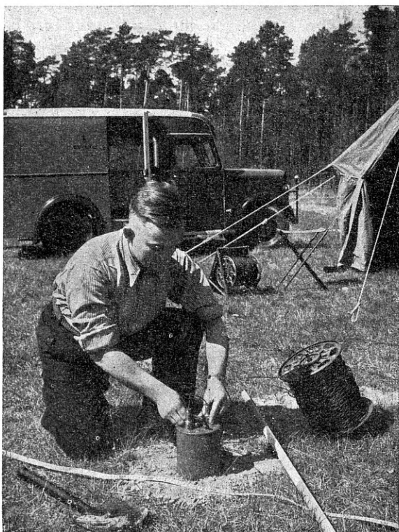
Joon. 6. Geofooni kuulamiskohale asetamine ja ta külge minevate juhtmete ühendamine.
