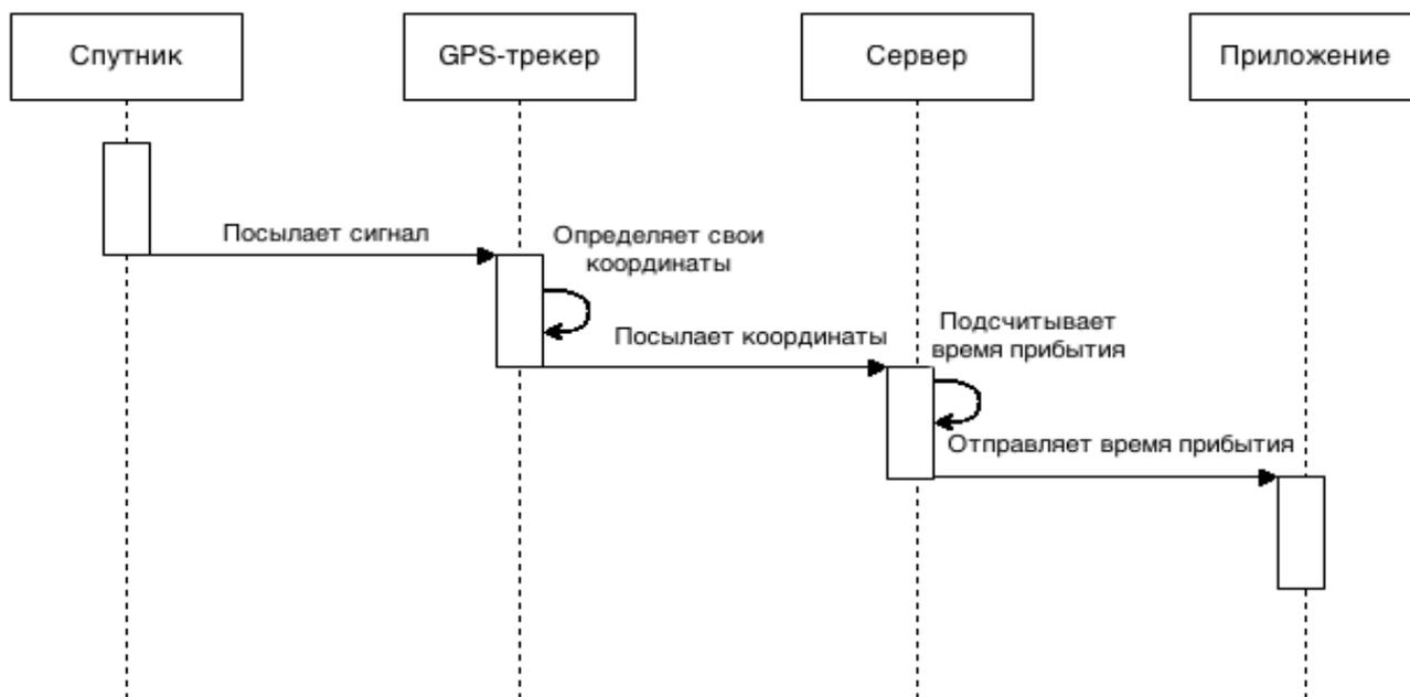
Рисунок 13. Диаграмма последовательности (Sequence Diagram)[3] Принцип работы системы позиционирования общественного транспорта.
