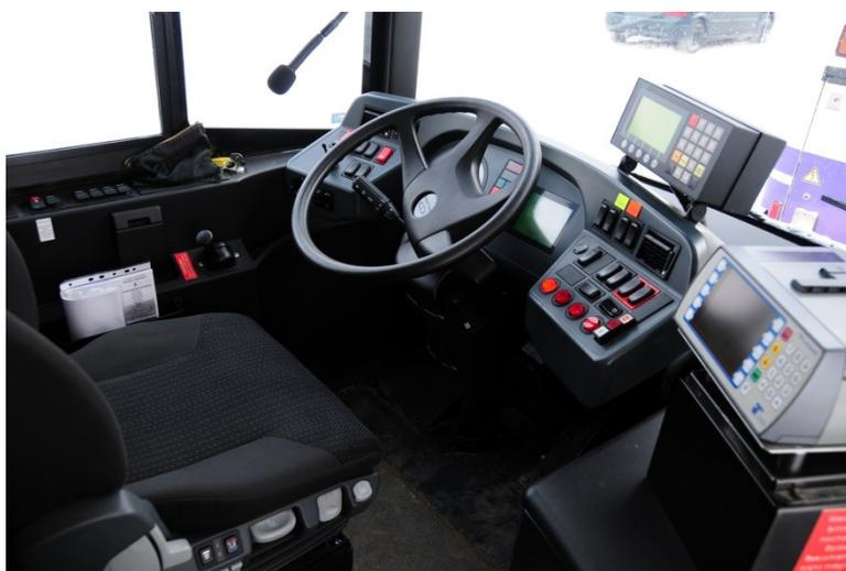
Рисунок 12: Бортовой компьютер в троллейбусах Solaris Trollino
